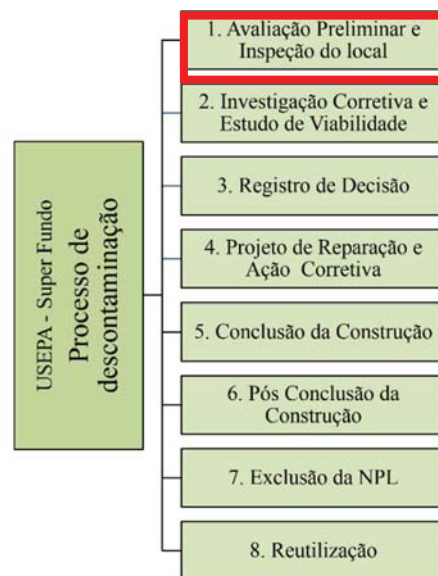
Figura 1 - Etapas do processo de gerenciamento de locais contaminados da Agência Norte-Americana de Proteção Ambiental
