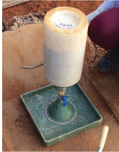
Figura 30 - Determinação do peso específico aparente seco do resíduo.
