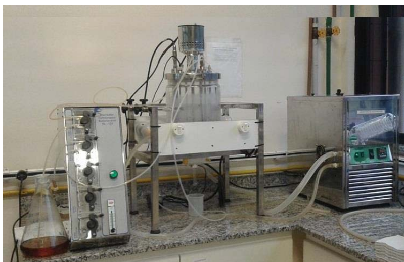
Figura 4 – Biorreator de bancada utilizado na produção de biossurfactante extracelular por S. cerevisiae
