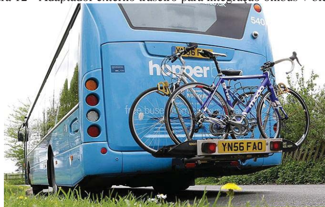
Figura 12 - Adaptador externo traseiro para integração ônibus + bicicleta
