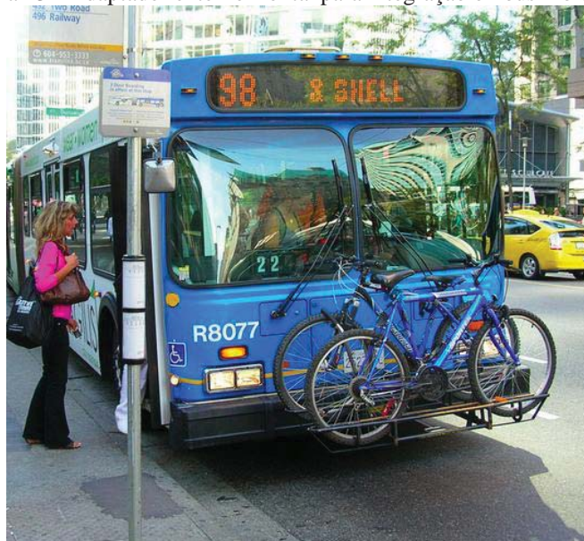
Figura 13 - Adaptador externo frontal para integração ônibus + bicicleta
