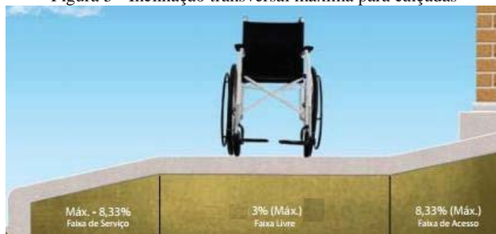
Figura 5 - Inclinação transversal máxima para calçadas
