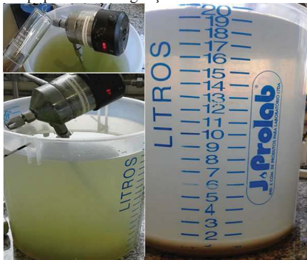
Figura 13 - Equipamento de agitação mecânica e amostra coagulada
