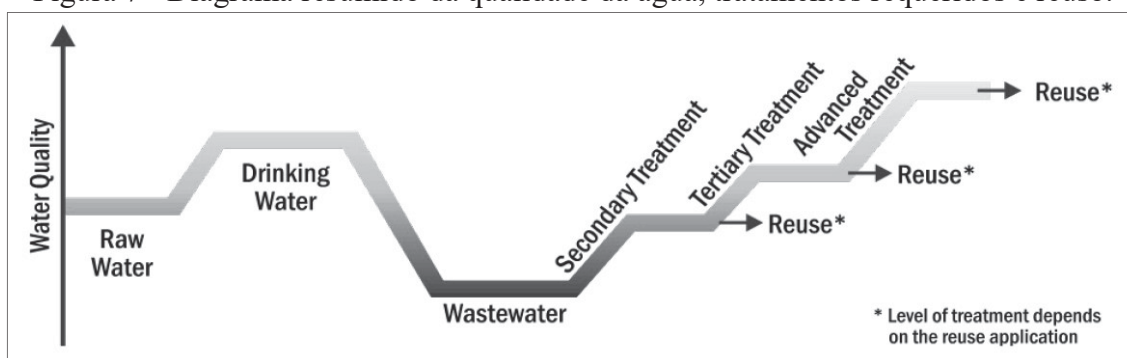
Figura 7 - Diagrama resumido da qualidade da água, tratamentos requeridos e reúso.
