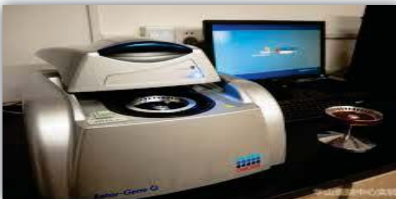
Figura 1- Plataforma de instrumentação para reação em cadeia pela polimerase em tempo real (Fabricante Qiagen ®). Fonte: Site da Qiagen ®
