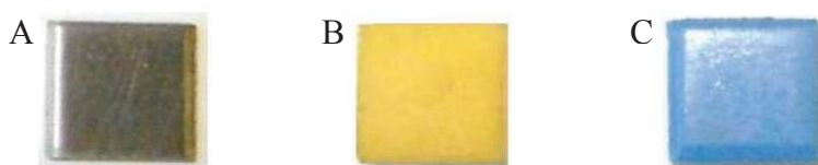
Figura 5 - Corpos de prova de aço inoxidável, polietileno e poliuretano provenientes de abatedouros avícolas.
