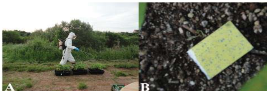
Figura 4 - A) Aplicação dos tratamentos; B) Cartão hidrosensível. Foto do autor.
