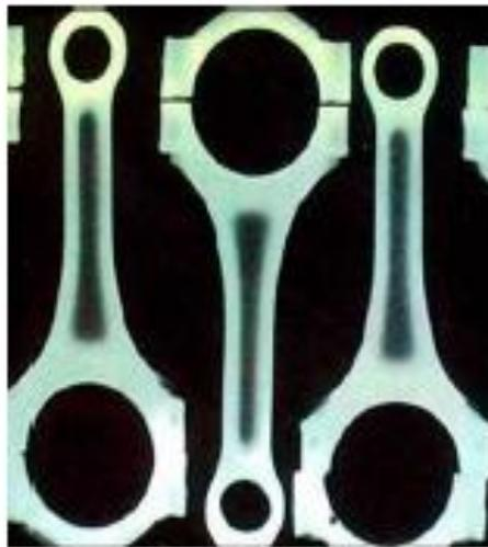
Radiografia de uma peça mecânica
