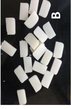
Figura 18. A– Cp cerâmicos após o corte. B- Cp cristalizados e glazeados.
