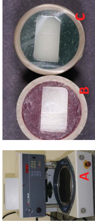
Figura 20. A– Máquina poliriz para polimento dos Cp. Aspecto do Cp antes (B) e após (C) o polimento de superfície.
