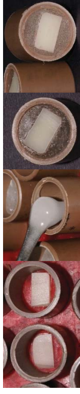
Figura 19. Sequência de inclusão dos Cp cerâmicos em resina acrílica, deixando exposta apenas a superfície a receber um dos quatro tratamentos adesivos experimentais, prévios à união ortodôntica direta dos bráquetes.
