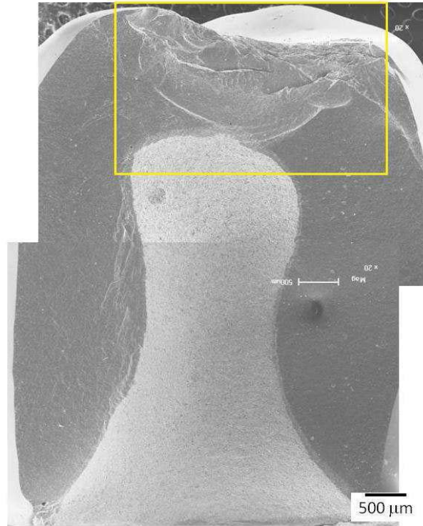
Figura 26– Imagem de MEV da superfície fraturada de uma coroa do grupo MC que apresentou lascamento da porcelana com exposição da IE de metal.
