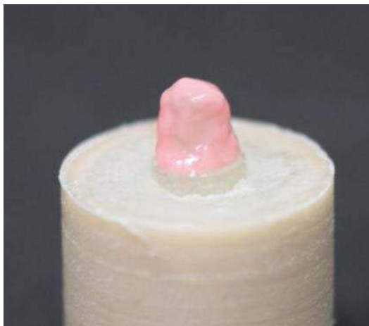
Figura 10– Pilar de G10 sendo condicionado com ácido fluorídrico.
