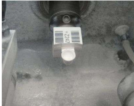
Figura 4– Bloco cerâmico pré-fabricado após a usinagem com o sistema CAD-CAM CEREC InLab.
