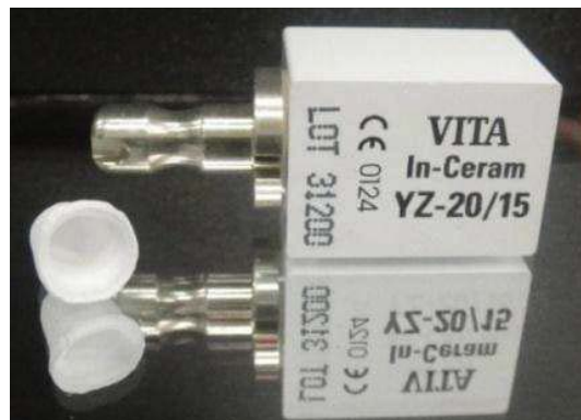
Figura 6– Imagem da mesma IE após o ciclo de sinterização.
