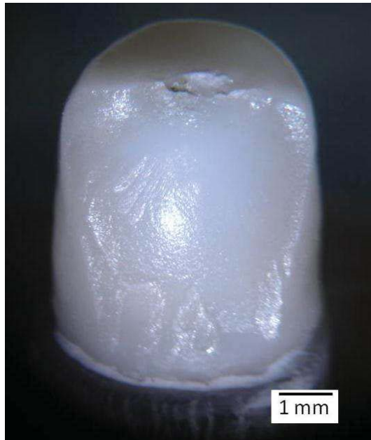
Figura 20– Tipo de fratura macroscópica observadas para o grupo YZ-C: lascamento da porcelana sem exposição da IE.
