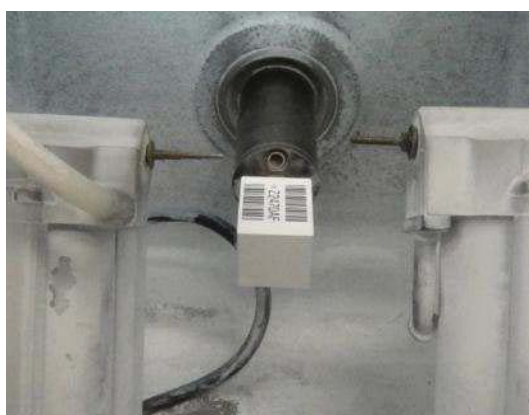
Figura 3– Bloco cerâmico pré-fabricado antes da usinagem com o sistema CAD-CAM CEREC InLab.
