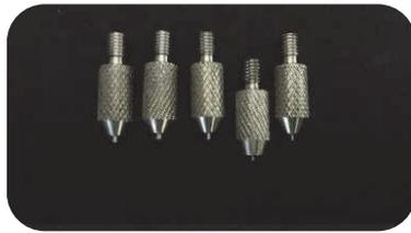
Figura 36 - Ponteiros para ensaio de push out
