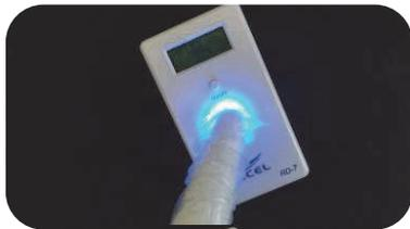
*Figura 26 - Aferição do comprimento de onda do LED*
