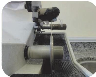
*Figura 5 - Remoção da coroa em cortadora metalográfica*
