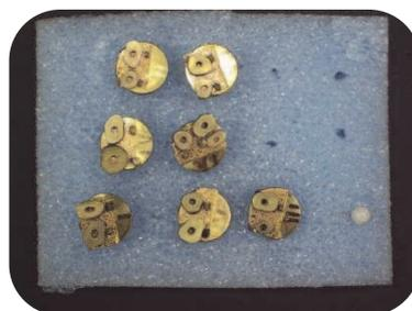
*Figura 42 – Amostras aderidas aos stubs e metalizadas com ouro para serem levadas ao Mev*
