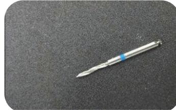
*Figura 13 - Broca para padronização do diâmetro interno dos canais*
