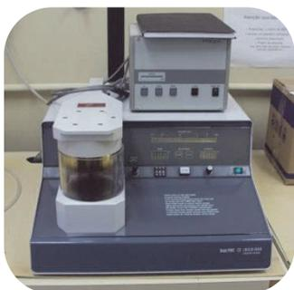
*Figura 41 – Ilustração da metalizadora*
