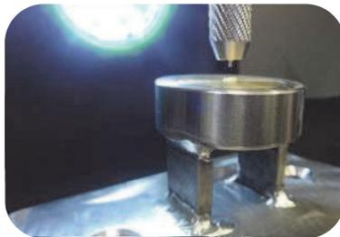
Figura 38 - Ensaio push out sendo realizado
