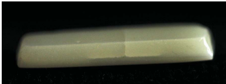
Figura 8. Corpo de prova fraturado evidenciando a trinca na porcelana de cobertura até a interface com a infraestrutura.
