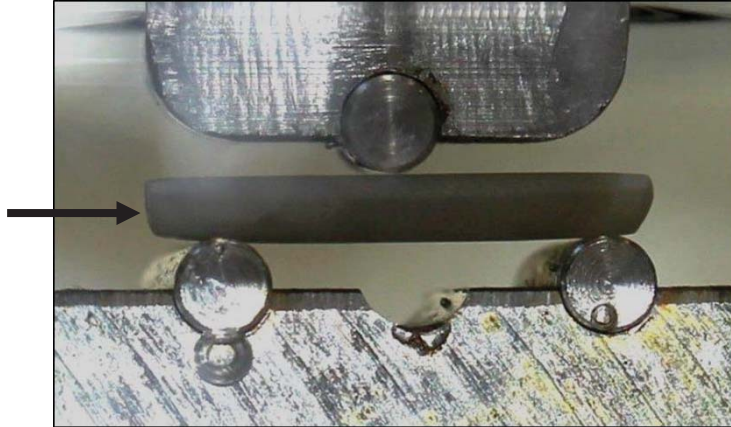
Figura 5. Configuração do teste de resistência à flexão em três pontos dos espécimes cerâmicos. A cerâmica de cobertura (seta) foi posicionada na área de maior concentração de forças de tração.
