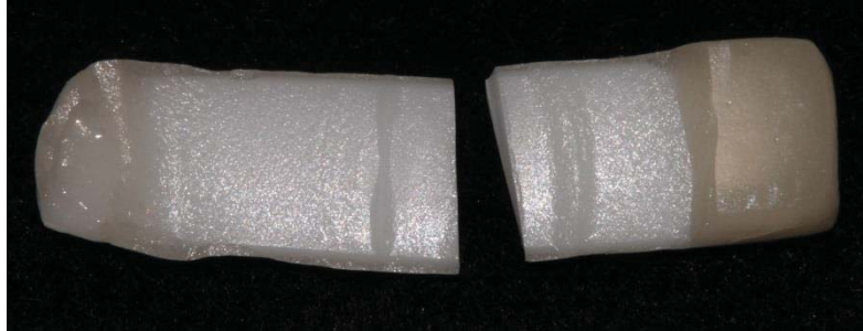
Figura 9. Corpo de prova fraturado evidenciando (falha catastrófica)- fratura de corpo inteiro.
