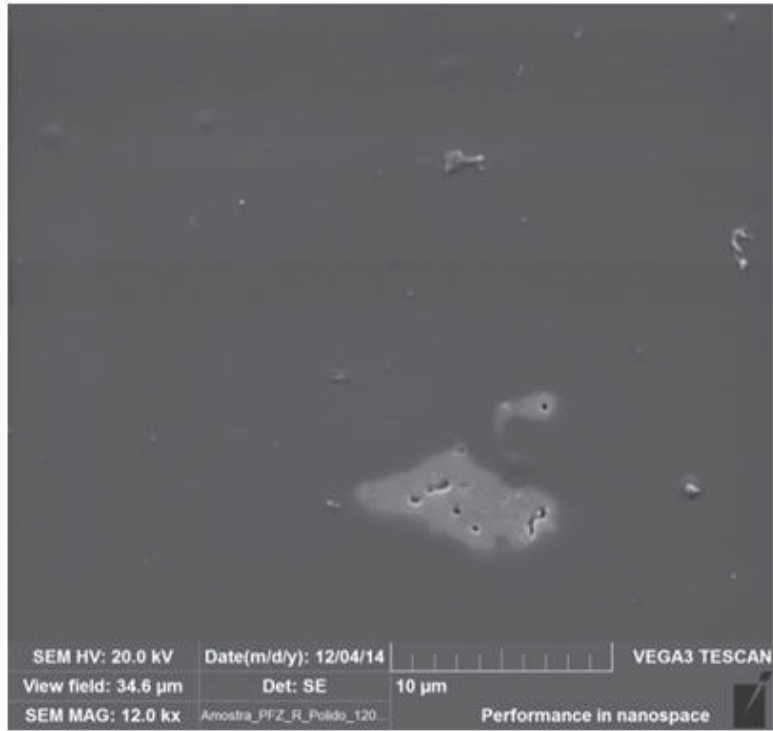
Figura 3. Características superficiais da porcelana Ceramco PFZ - superfície livre de aglomerados de partículas.
