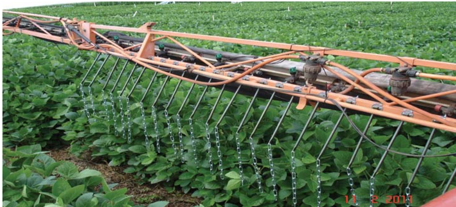
Figura 7 - Cortina de correntes acoplada à barra de pulverização. Fonte: Boller, W.
