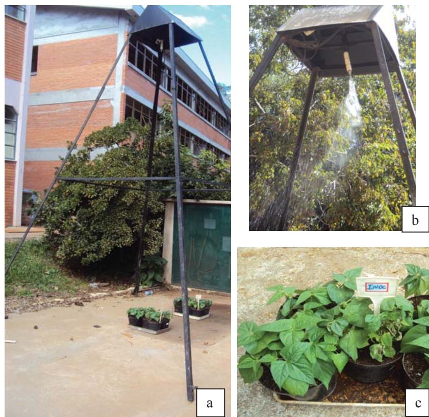
Figura 1 - Simulador de chuva em estrutura metálica (a); detalhe do aspersor, modelo Veejet 80100 ligado e apresentando jato tipo leque (b); Disposição de quatro vasos com plantas saudáveis ao redor de um vaso com planta doente.
