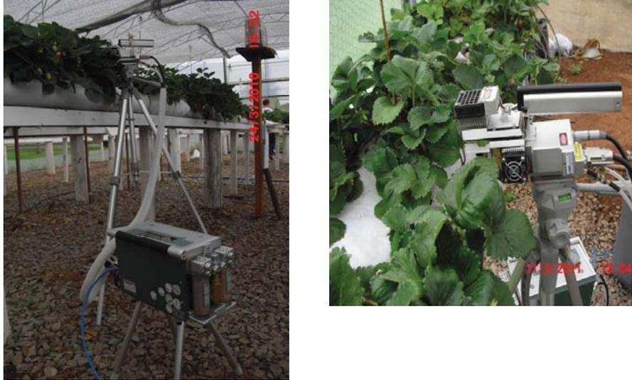
**Figura 3** - Analisador de gases por radiação infra-vermelha (IRGA) equipado com câmara de topo fechada.
