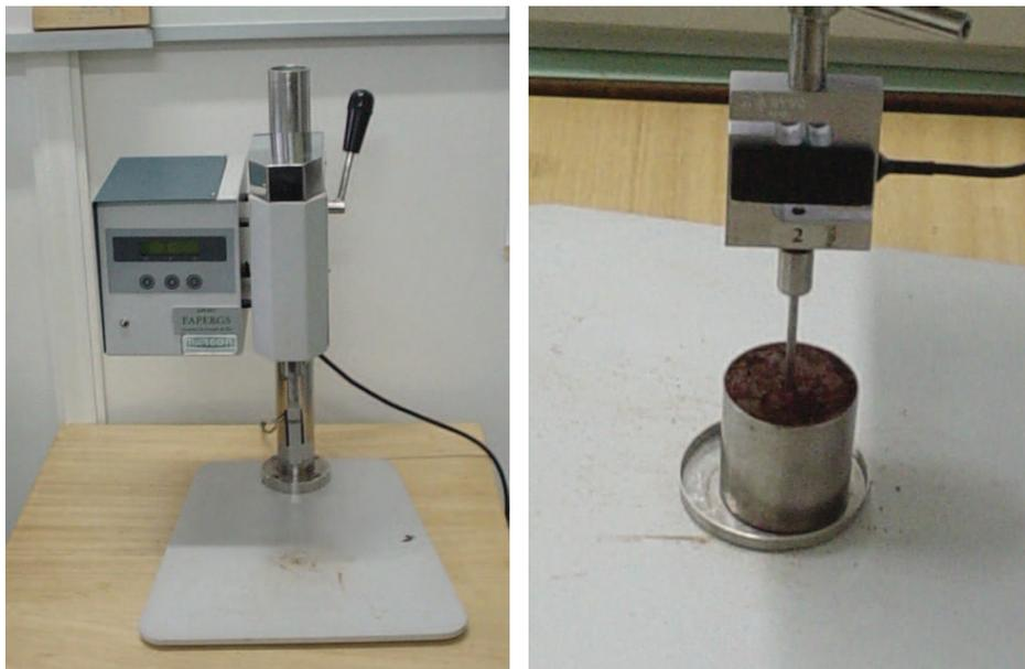
Figura 3 - Aparelhos de determinação da resistência mecânica do solo à penetração em laboratório, penetrômetro eletrônico modelo MA-933, marca Marconi.
