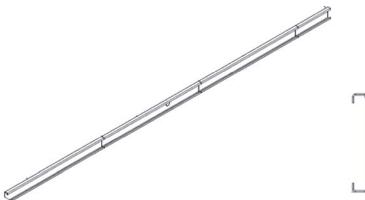
Figura 3.3 - Perfil da viga estrutural do chassi
