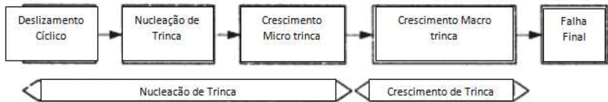
Figura 1 - Evolução de uma trinca de fadiga
