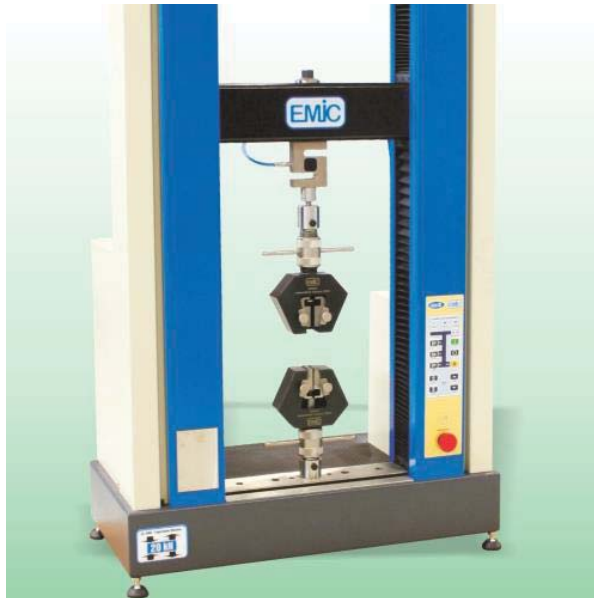
Figura 29 – Equipamento de ensaio de tração EMIC DL 3000.
