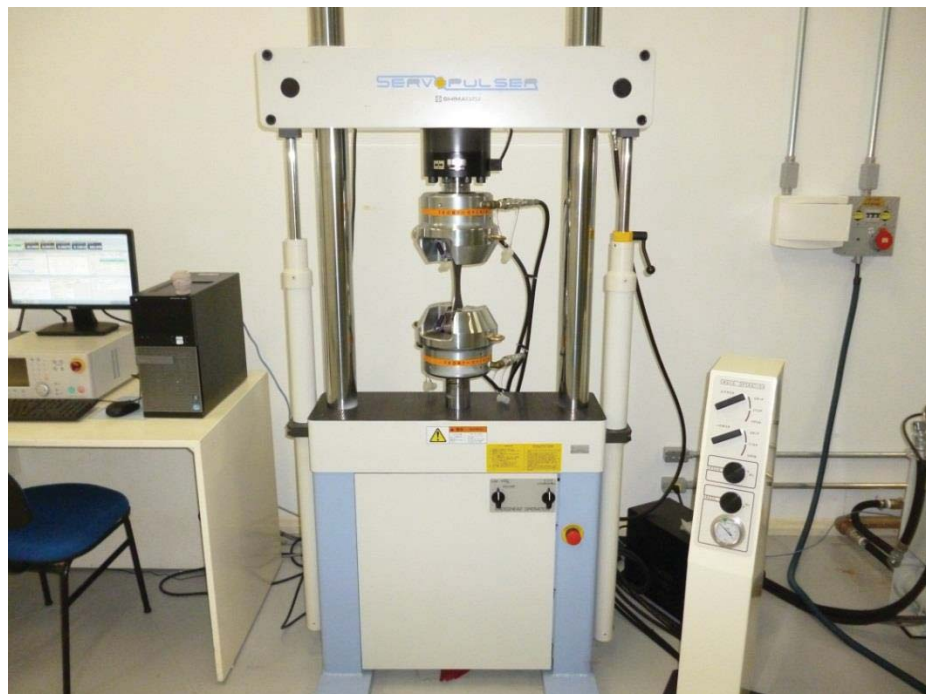
Figura 32 – Equipamento Shimadzu utilizados na realização dos ensaios dinâmicos.
