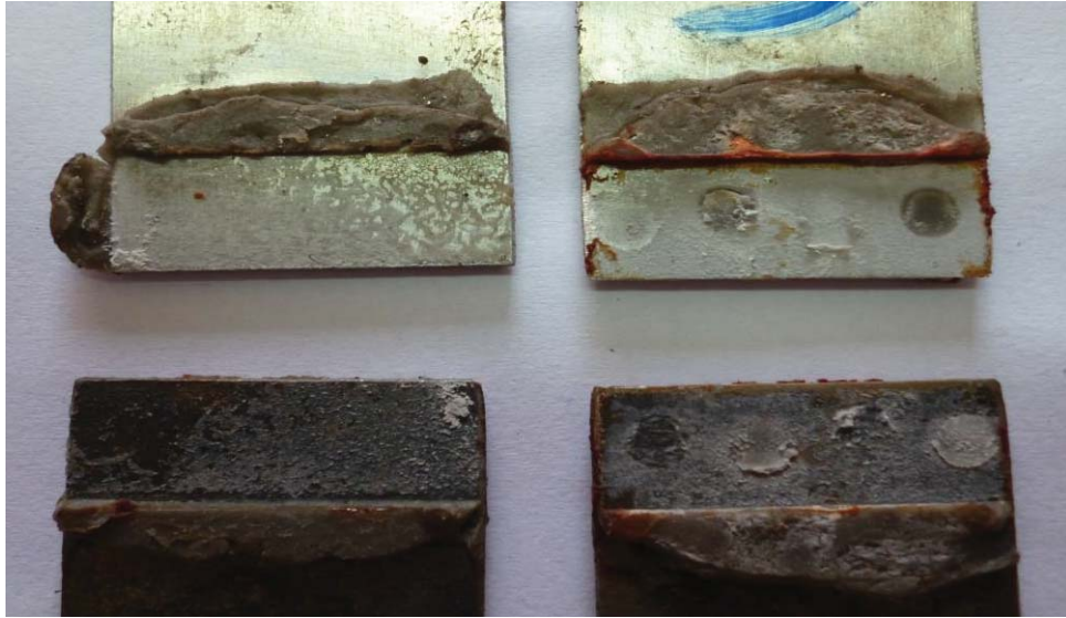
Figura 50 – Fratura nos corpos de prova submetidos ao ensaio de fadiga.
