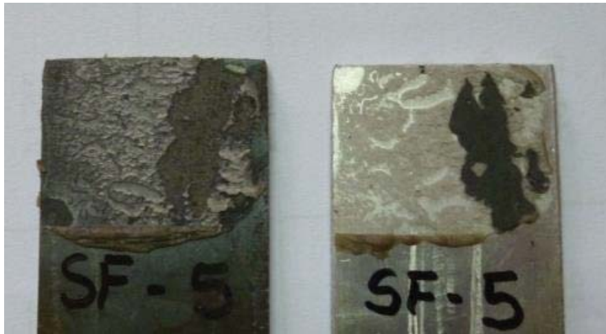
Figura 34– Corpo de prova SF-25,4-5, falha do tipo mista entre falha coesiva do adesivo e falha coesiva do substrato.
