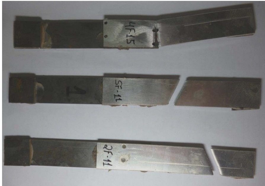
Figura 36 – Falha coesiva do alumínio.
