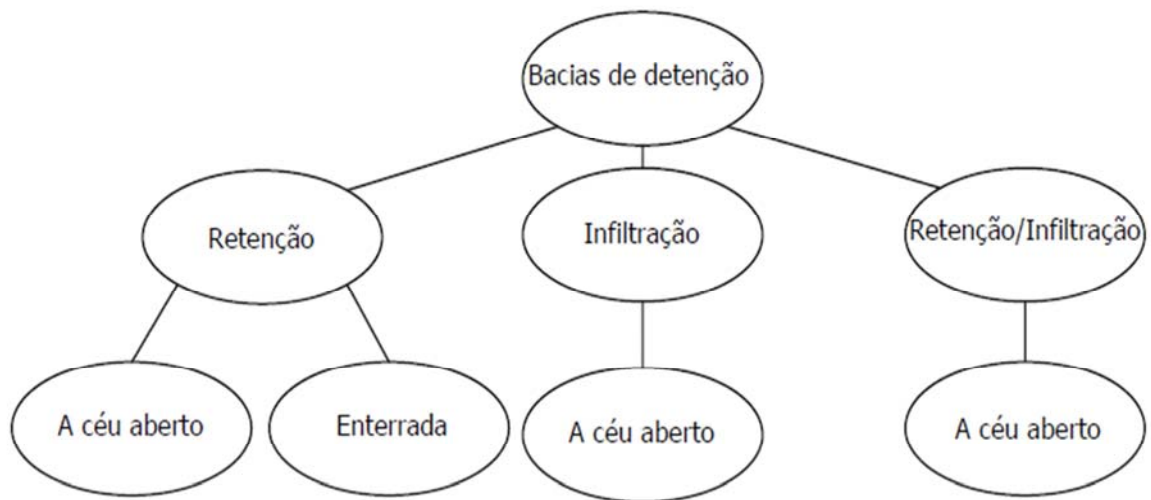
Figura 7 - diferentes tipos de bacias de retenção.
