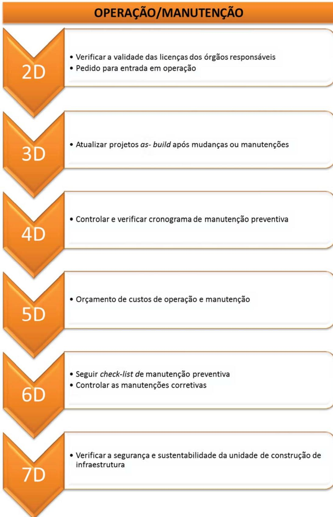
Figura 19: Etapa de desativação do ciclo de vida de unidades de construção de infraestrutura e as dimensões do BIM
