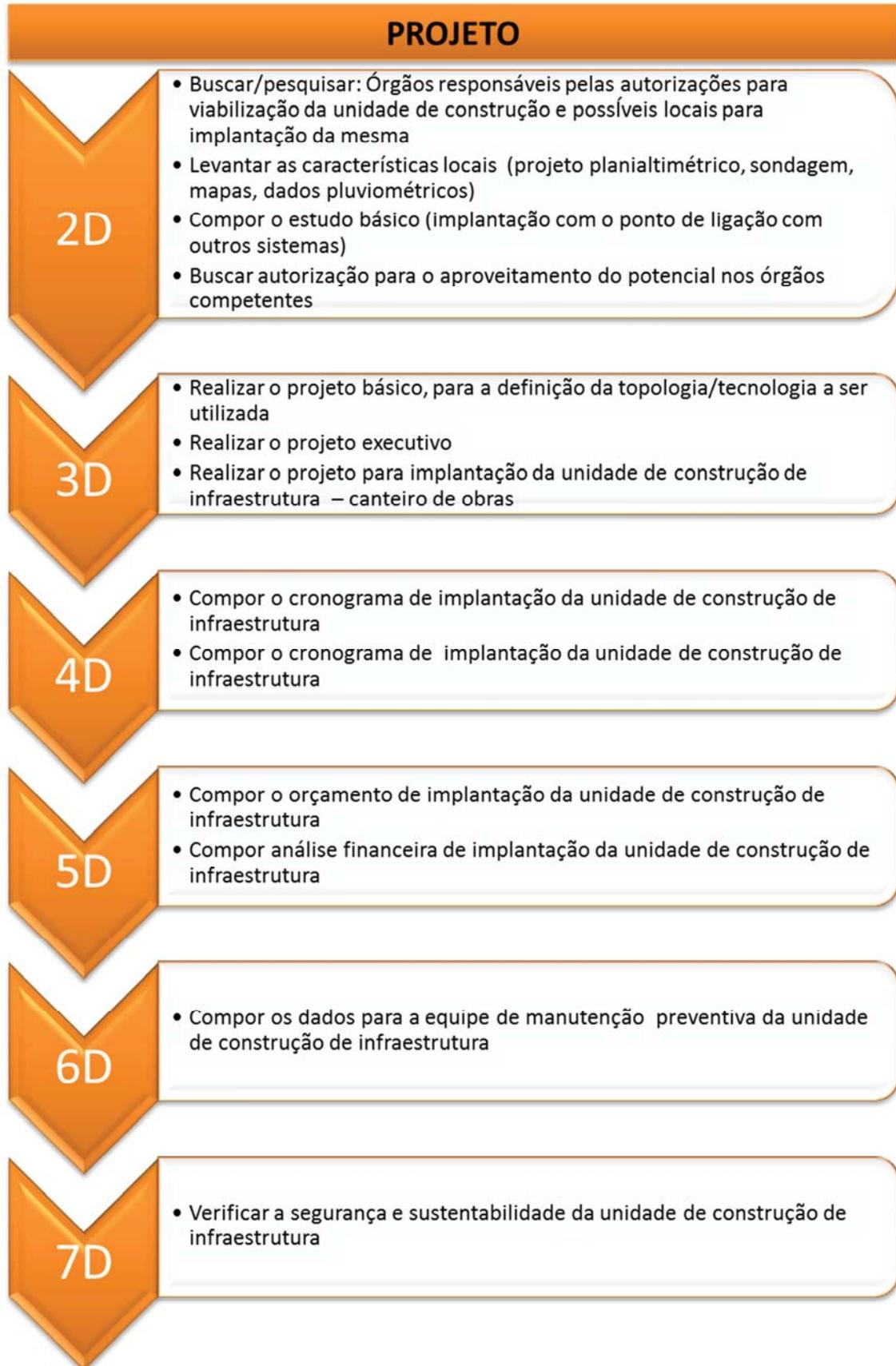
Figura 17: Etapa de execução do ciclo de vida de unidades de construção de infraestrutura e as dimensões do BIM
