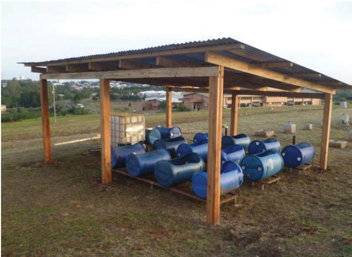
Os reatores foram dispostos lado a lado, numerados e adaptados com um dreno individual (Figura 6), para controle do excesso de umidade. Ao dreno era acoplado um registro para retirada do percolado, evitando uma eventual contaminação do solo. O
