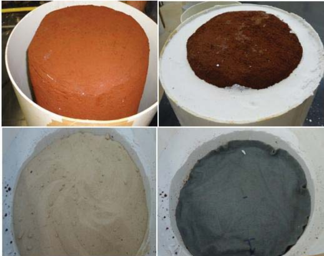
Figura 16. Moldagem dos corpos de prova.
