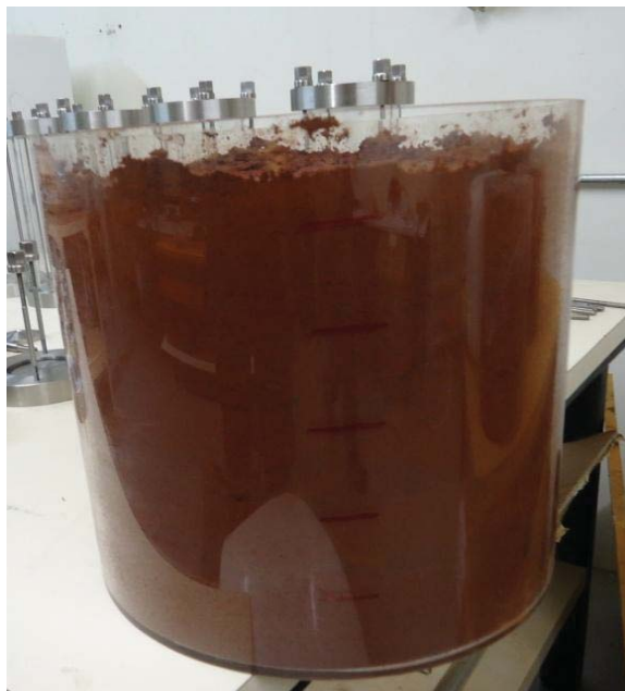
Figura 29. Corpo de prova com pressão aplicada de 25 kPa.
