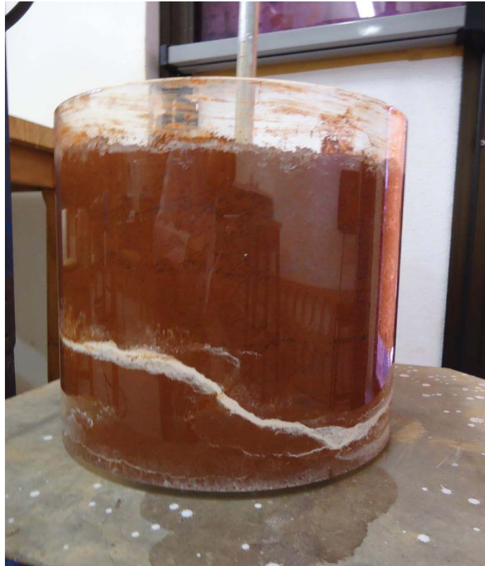
Figura 21. Corpo de prova deformado com pressão injetada de 300 kPa.
