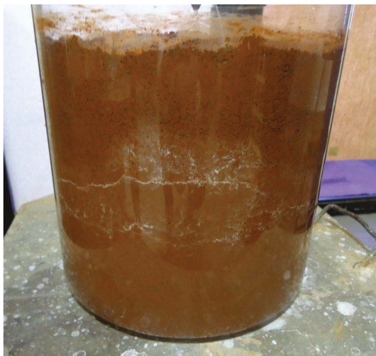
Figura 26. Vista externa do corpo de prova injeção de pressão de 75 kPa.
