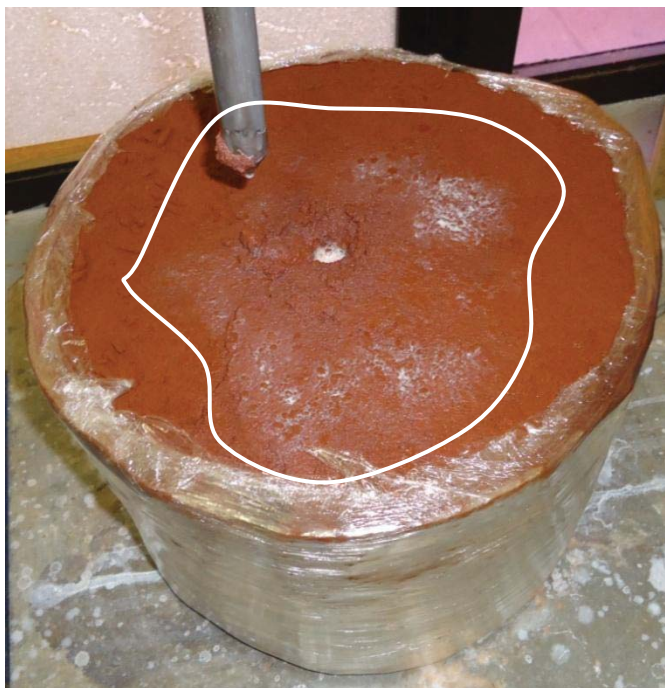
Figura 31. Área de abrangência do corpo de prova indeformado com pressão aplicada de 100 kPa.
