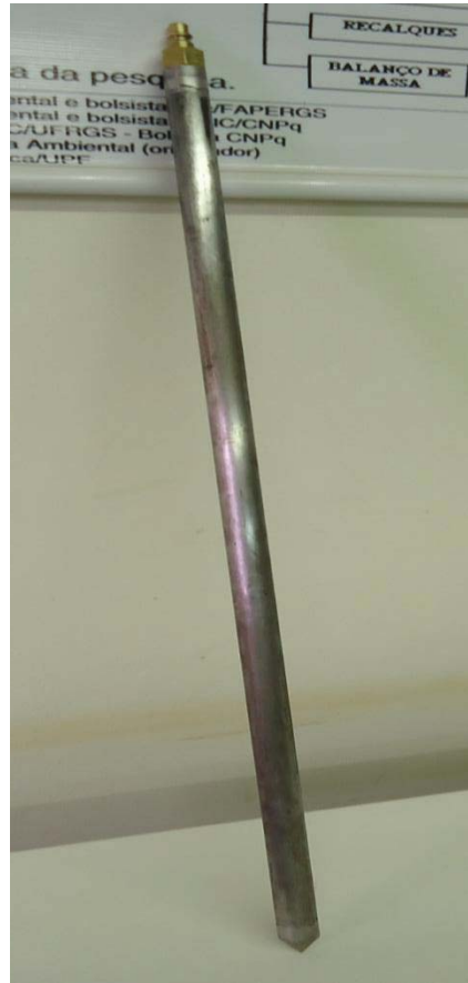
Figura 11. Vista geral da haste de injeção.
