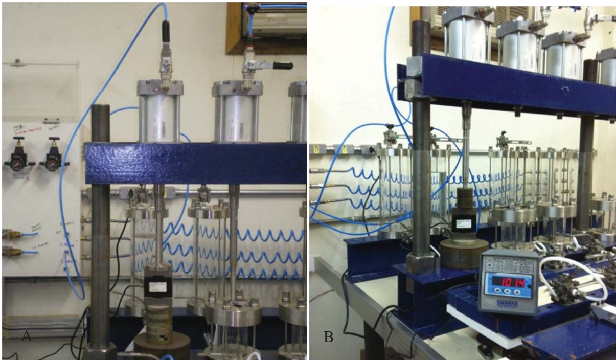
Figura 44: Aplicação de força com o cilindro pneumático.
