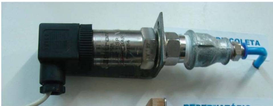
Figura 26: Transdutor de pressão – SP2.
