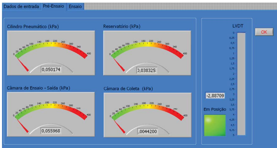
Figura 33: Interface IHM instantânea desenvolvida para o pré-ensaio.
