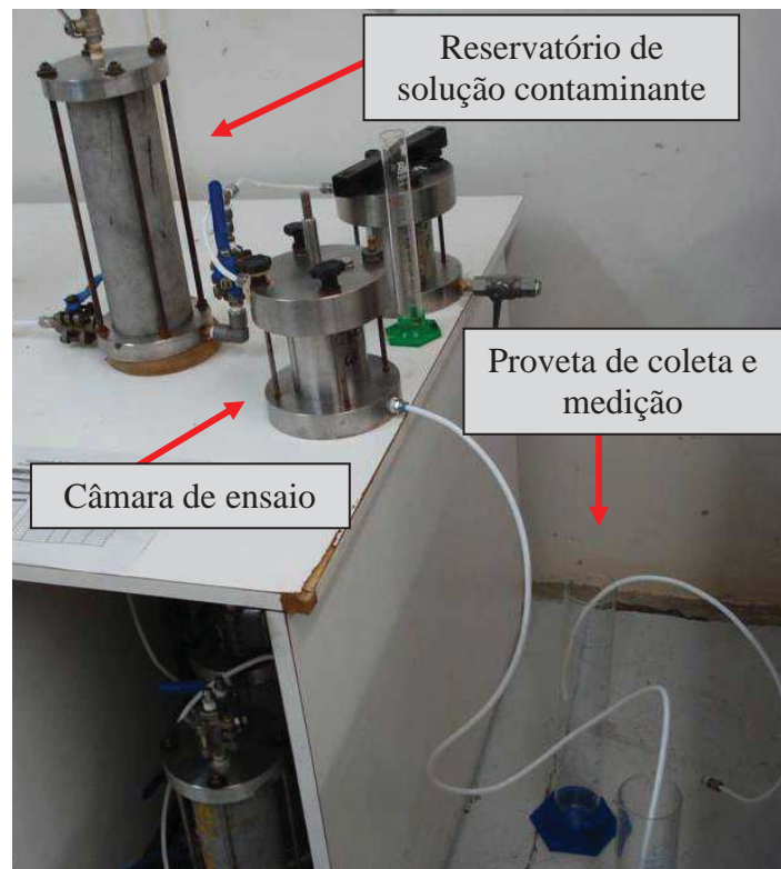
Figura 10: Célula de adensamento adaptada para ensaio de coluna.
