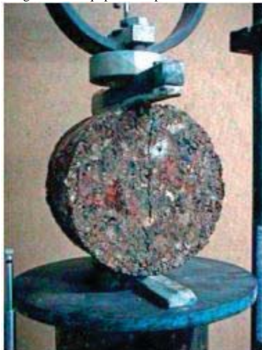
Figura 27 – Equipamento para ensaio de RT.
