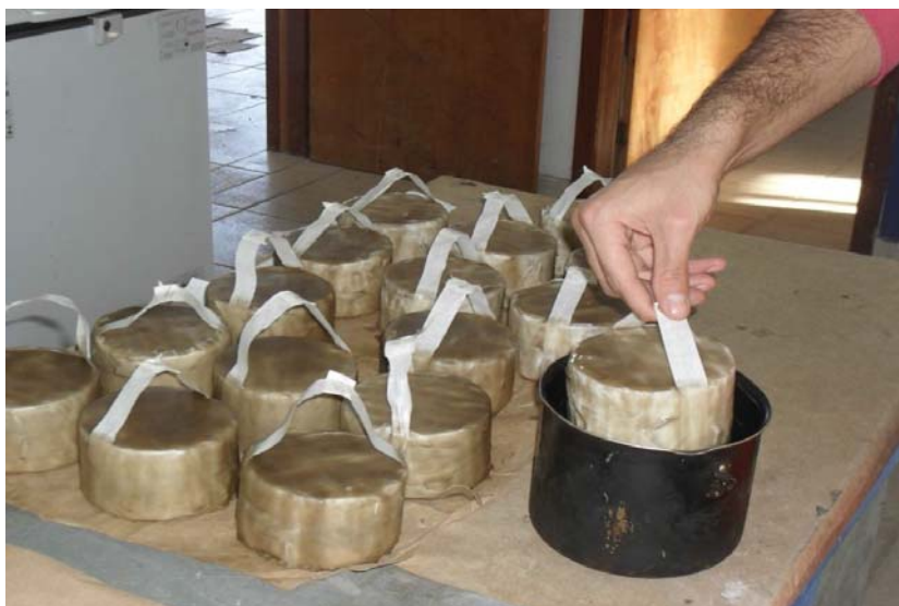
Figura 24 – Corpos-de-prova sendo parafinados.
