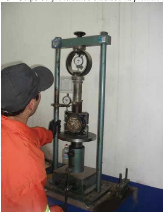
Figura 26 – Corpo-de-prova sendo ensaiado na prensa Marshall.
