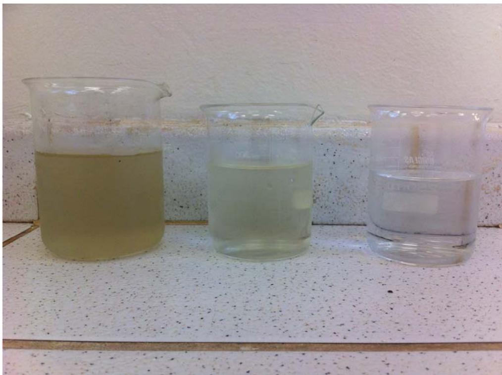
Figura 30: Da esquerda para a direita: Efluente, permeado e água destilada.
