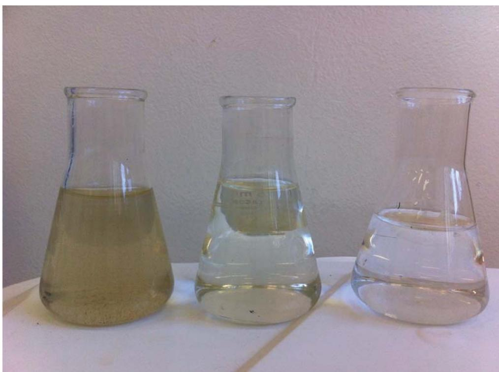
Figura 31: Da esquerda para a direita: Efluente, permeado, efluente com carvão lavado e permeado com carvão lavado.
