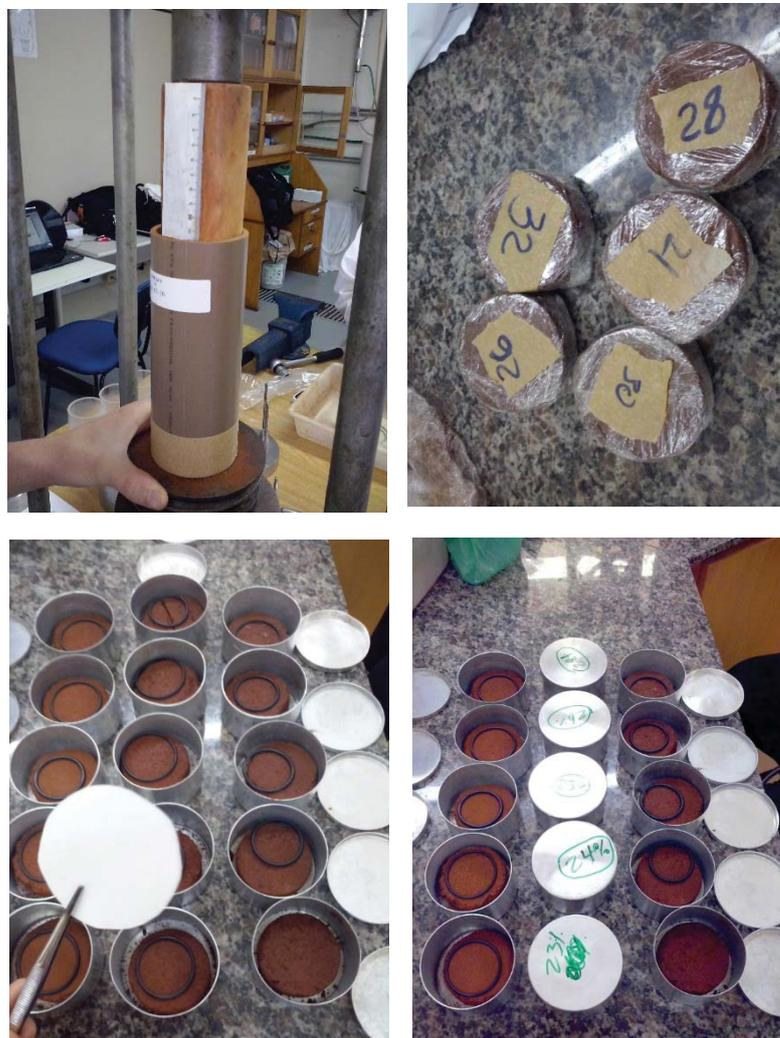
Os nutrientes foram adicionados ao solo na relação de 100:10:10:1 (C:N:P:K). Como variável de resposta foi considerado o valor de sucção obtido através do método de papel filtro em função das diferentes índices de vazios e umidades propostas para o sistema.
