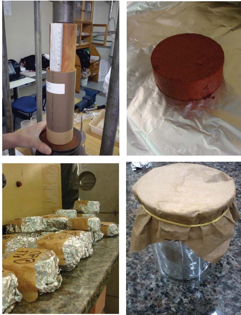
Uma vez que o experimento visa à avaliação das reações unicamente físico-químicas realizadas pelo solo e seus componentes, os corpos de prova moldados foram submetidos a um processo de esterilização objetivando eliminar a possibilidade de ação de microrganismos no meio.
