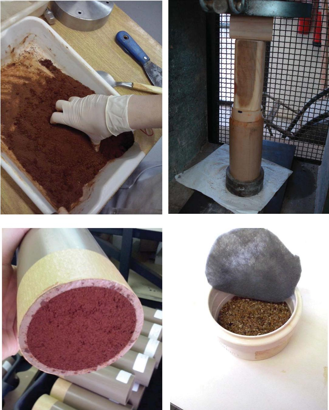
Na moldagem dos corpos de prova (CP) foram utilizados os valores de índice de vazios e umidade que contemplassem as configurações estabelecidas no planejamento experimental. Visando proporcionar uma melhor homogeneidade dos corpos de prova, optou-se por manter o valor de massa de solo seco utilizado (400 gramas) constante para todos os corpos de prova, variando a altura dos mesmos e atender os índices de vazios estipulados no
