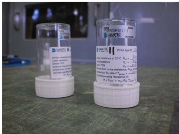
Figura 72: Sonda utilizada modelo 55P11 (fio reto)
