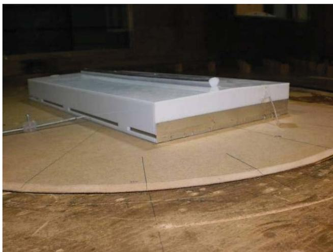
**Figura 80: Fechamento das aberturas do modelo com fita de alumínio.**
