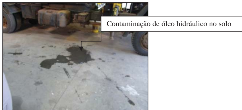
Figura 80 - Contaminação de óleo no solo
