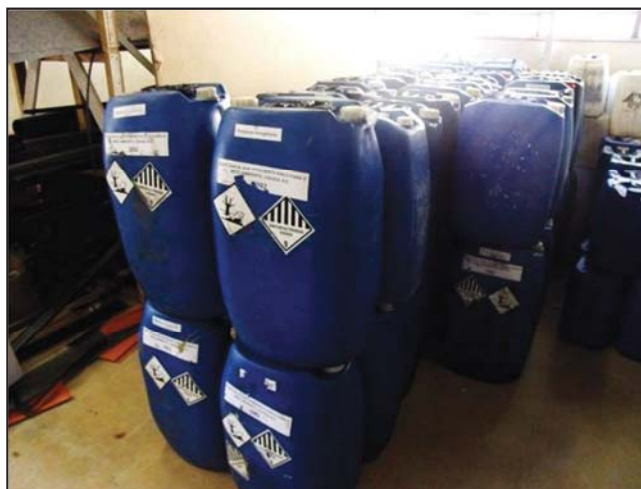
Figura 87 - Bombona para acondicionamento de efluentes.
