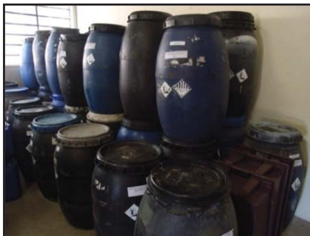
Figura 83 - Bombona para acondicionamento de resíduos sólidos de óleo
