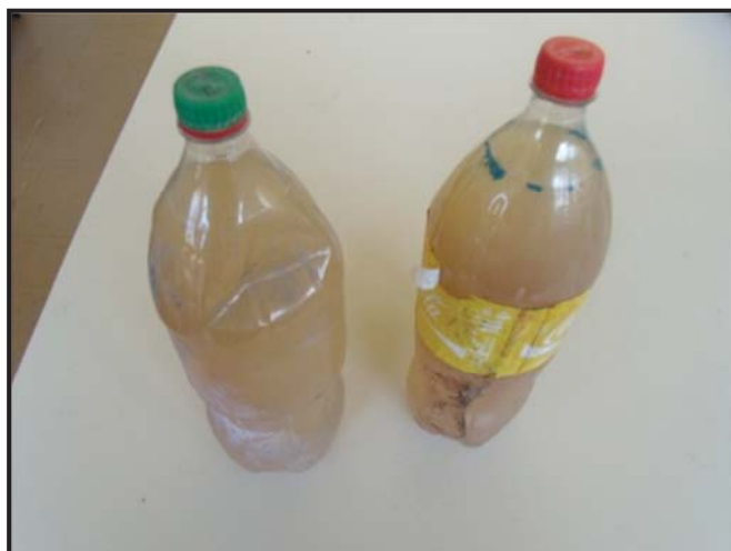
Figura 88 - Efluente contaminado da pintura
