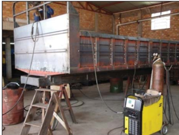
Figura 29 - Soldagem GMAW-MAG da empresa em estudo
