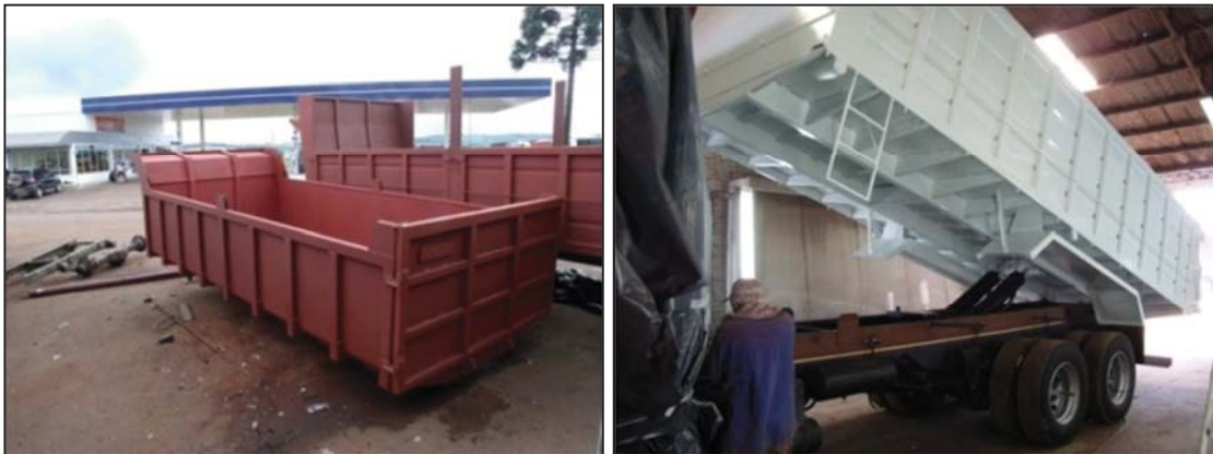
Figura 37 - Pintura primer, esmalte e resíduos de tinta fabrica antiga (a) Pintura Primer (b) Pintura esmalte
