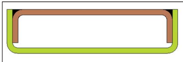
Figura 64 - Perfil das vigas das caçambas.
