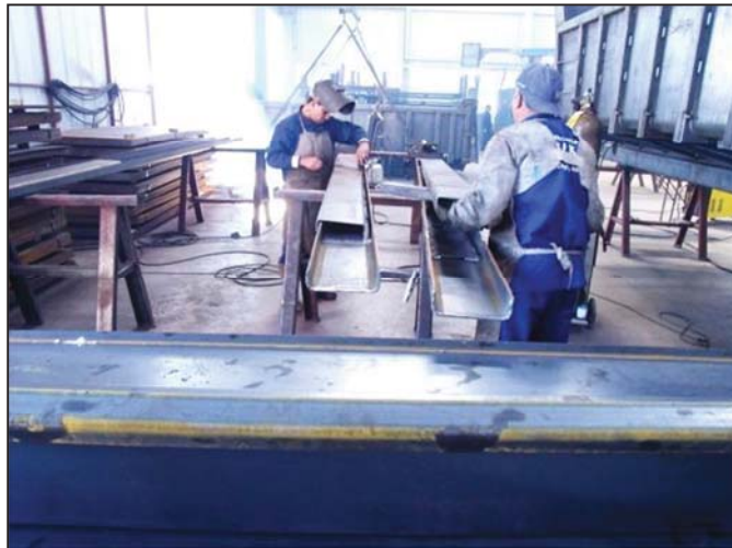
Figura 62 - Vigas das caçambas basculantes processo GMAW-MAG.
