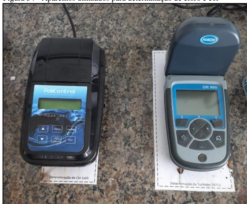
Figura 34 - Aparelhos utilizados para determinação de cloro e cor
