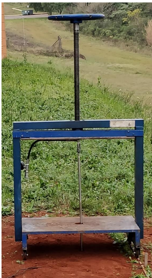
Figura 2: Equipamento para injeção de nZVI no solo.
