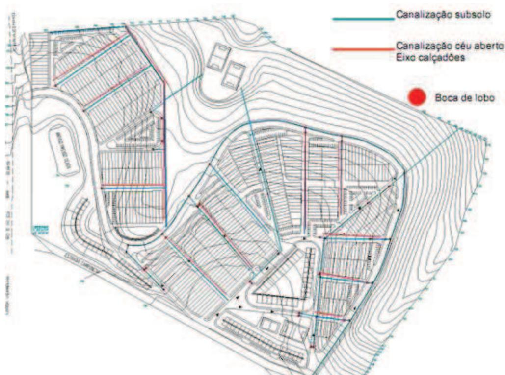
Figura 144: Implantação – Sistema de canalização pluvial
