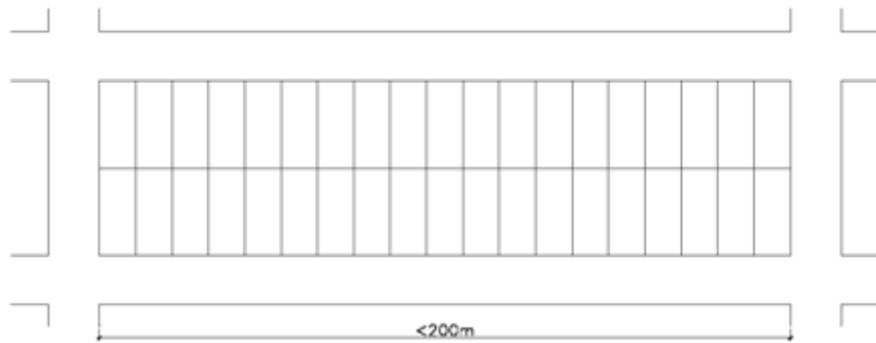
Figura 11: Traçado de quadra com terrenos tangenciando a rede de infraestrutura
