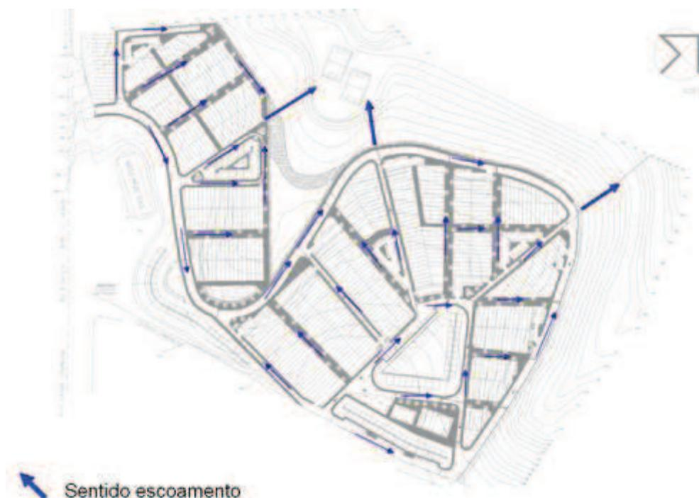
Figura 143: Implantação – Sentido de escoamento pluvial
