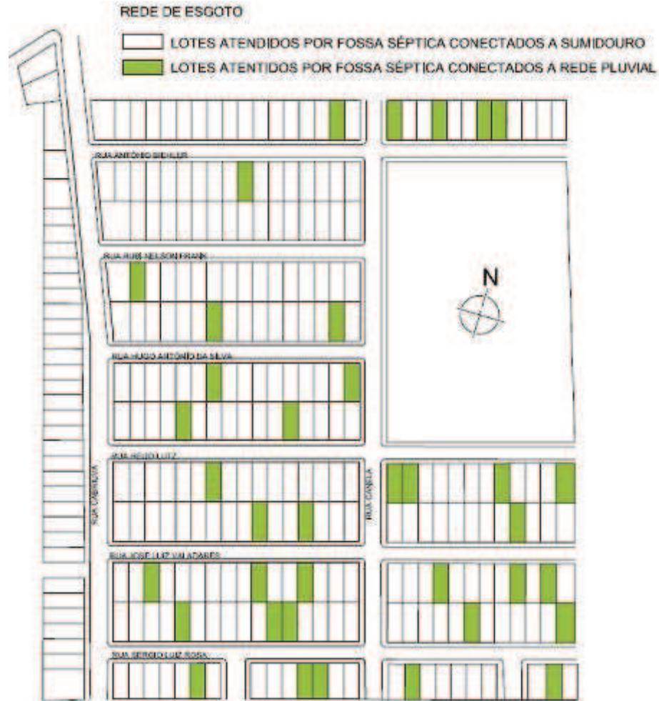
Figura 94: Implantação: lotes atendidos por rede de esgoto loteamento Bem-te-vi
