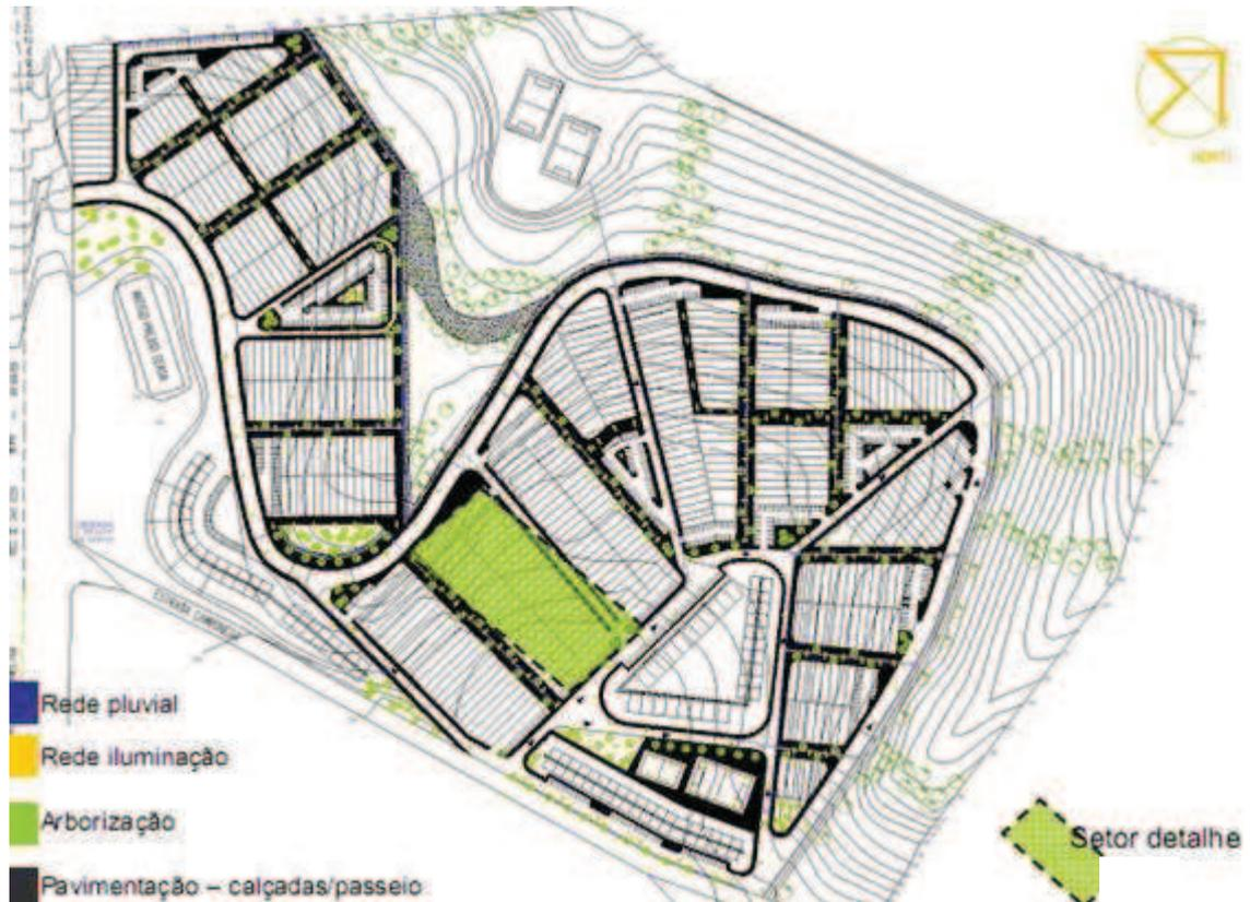
Figura 136: Implantação das redes de infra-estrutura
