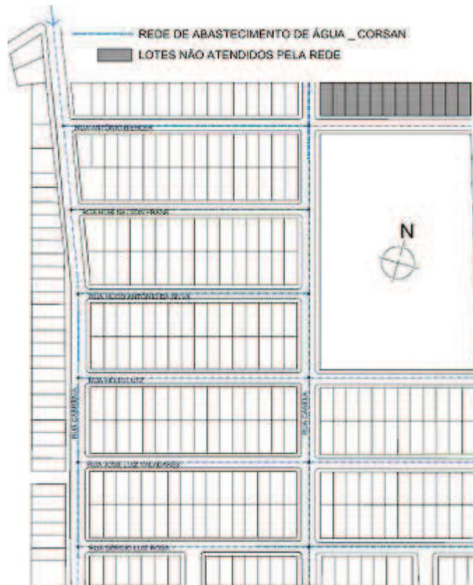
Figura 91: Implantação: Rede abastecimento de água loteamento Bem-te-vi
