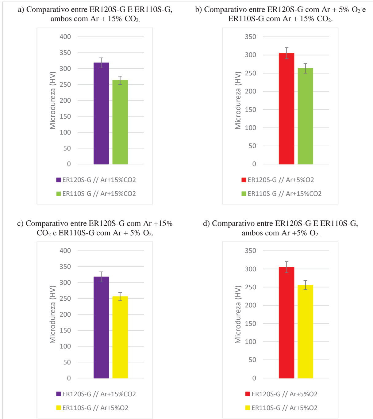
Figura 32 - Comparativo entre médias de valores de microdureza na região de metal de adição para os eletrodos ER110S-G e ER120S-G com variação dos gases de soldagem.
