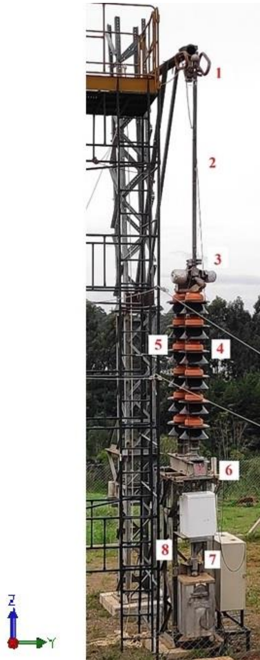
Figura 19 – Posicionamento strain gages seccionador BMKU – 40A
