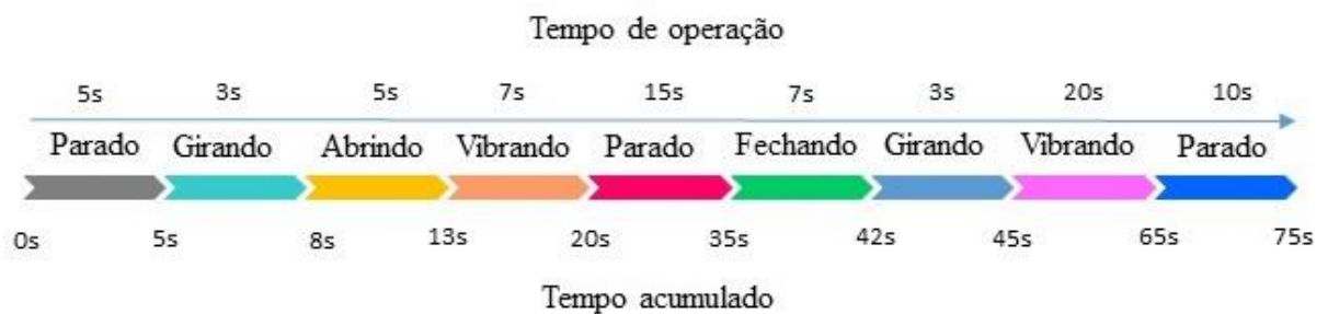
Figura 21 – Ação do seccionador ao longo do tempo
