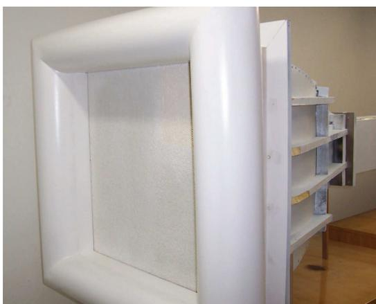
Figura 9 – Convergente, colméia e lábios, vista externa de um túnel de vento (FAUTH 2006)
