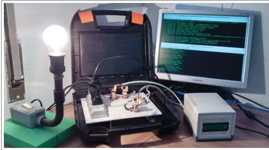
Figura 24. Fotografia com o sistema todo na bancada, durante um teste de aquisição utilizando lâmpada incandescente (do autor).
