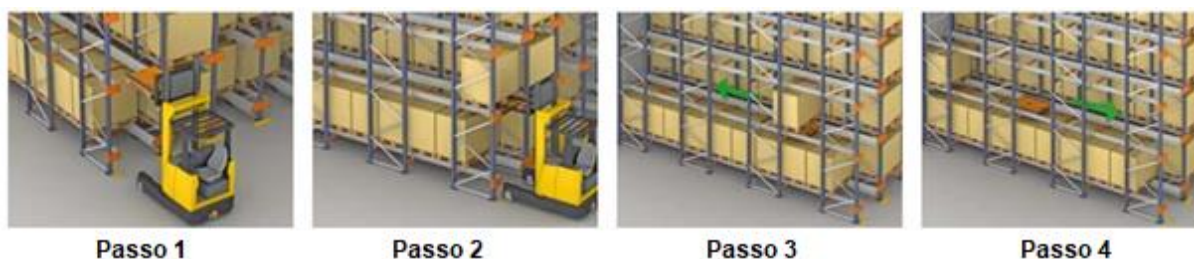
Figura 19 - Procedimento operacional do sistema de carro satélite de armazenagem
