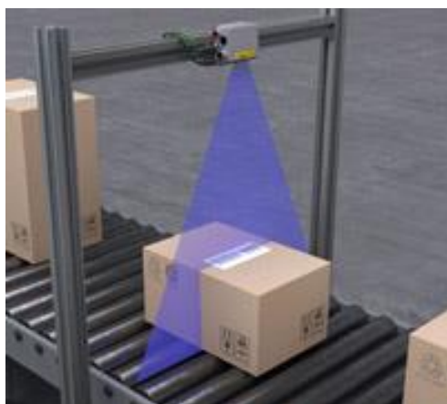
Figura 10 - Aquisição automática de código de barras
