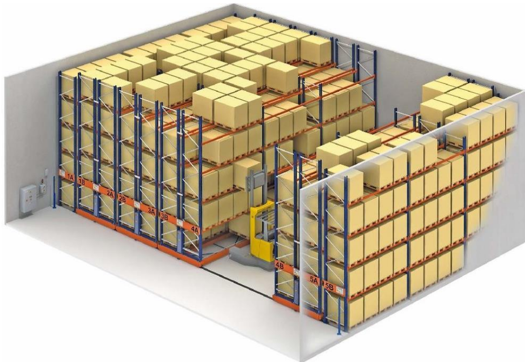
Figura 17 - Sistema base móvel de armazenagem
