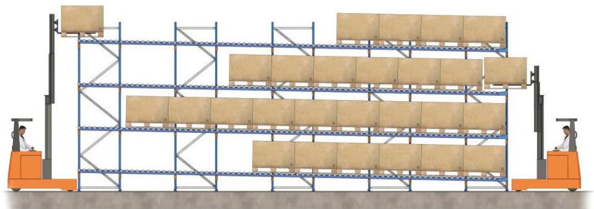
Figura 16 - Sistema de armazenagem dinâmico
