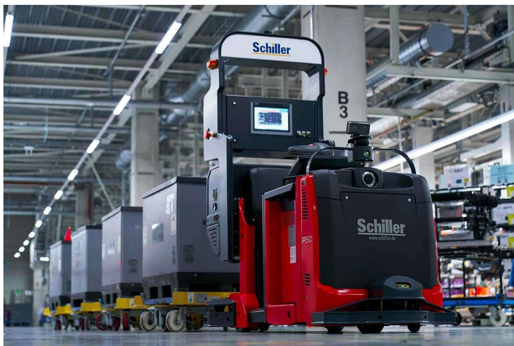
Figura 5 - Trem de reboque autônomo utilizado na fábrica do BMW Group em Regensburg
