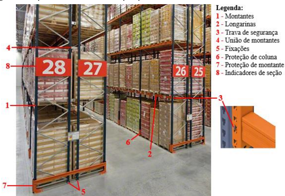
Figura 37 - Componentes básicos de um sistema porta palete convencional
