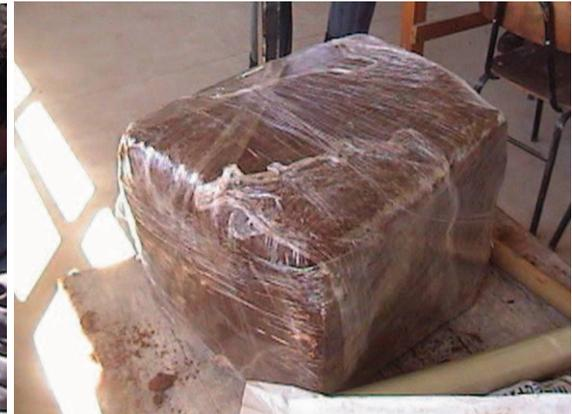
Figura 3.16 Bloco totalmente revestido com filme de PVC transparente.
