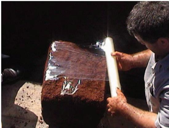
Figura 3.15 Proteção do bloco de solo utilizado na confecção dos corpos de prova.
