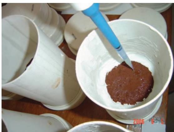
Figura 3.49 Aplicação das bactérias bioaugmentados no solo.
