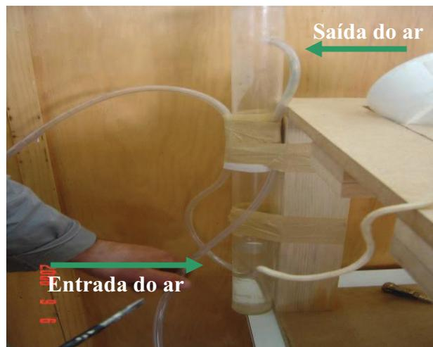
Figura 3.9 Equipamento de purificação do ar.
