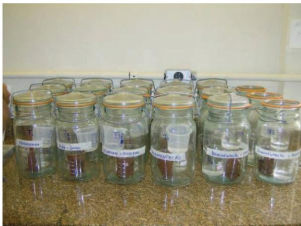
Figura 3.50 Experimento de Evolução do CO<sub>2</sub>.
