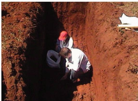
Figura 3.11 Vala para coleta do solo. Figura 3.12 Coleta das amostras deformadas.
