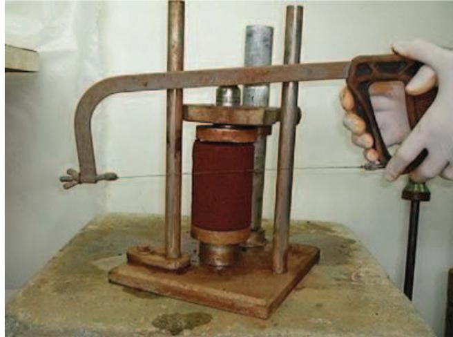
Fig. 3.17 Moldagem da amostra indeformada do solo.
