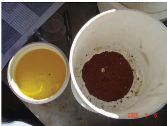
Figura 3.25 Corpo de prova após contaminação com biodiesel.
