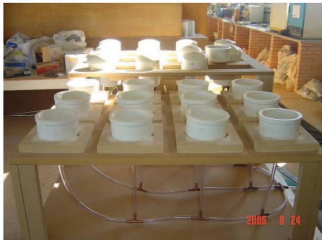
Figura 3.7 Montagem do equipamento de aeração.
