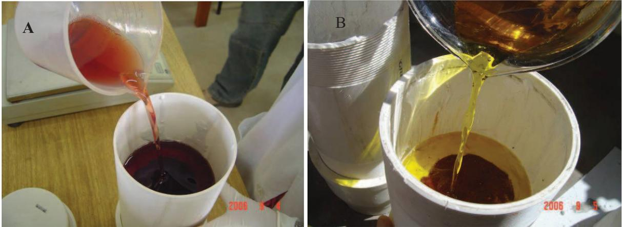
Fig. 3.21 Contaminação: A) com óleo diesel) e B) com biodiesel.
