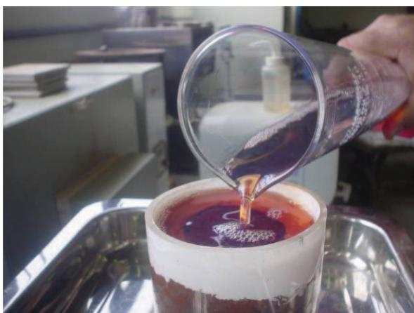
Figura 3.19 Amostra 1 sendo contaminada com 25% de óleo diesel.
