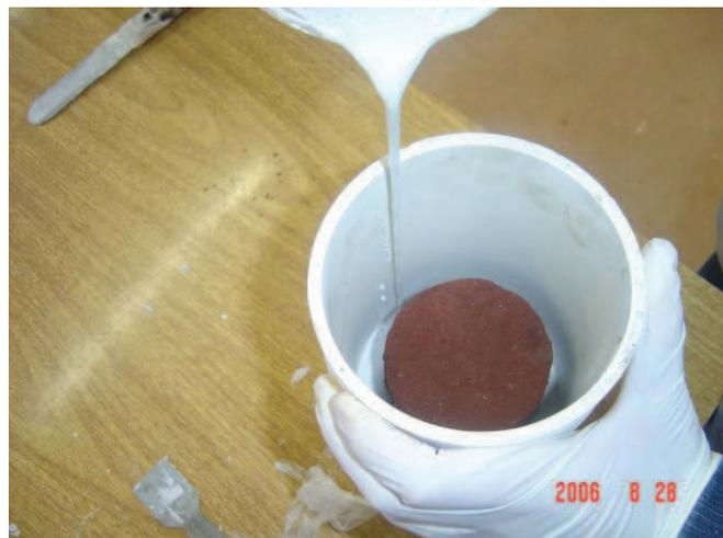
Figura 3.18 Corpo de prova sendo revestido com gesso.
