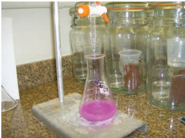
Figura 3.51 Amostra sendo feita a titulação com HCl.
