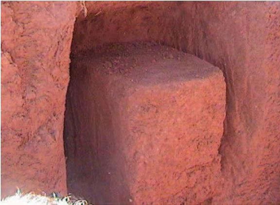
Figura 3.13 Moldagem do bloco.
