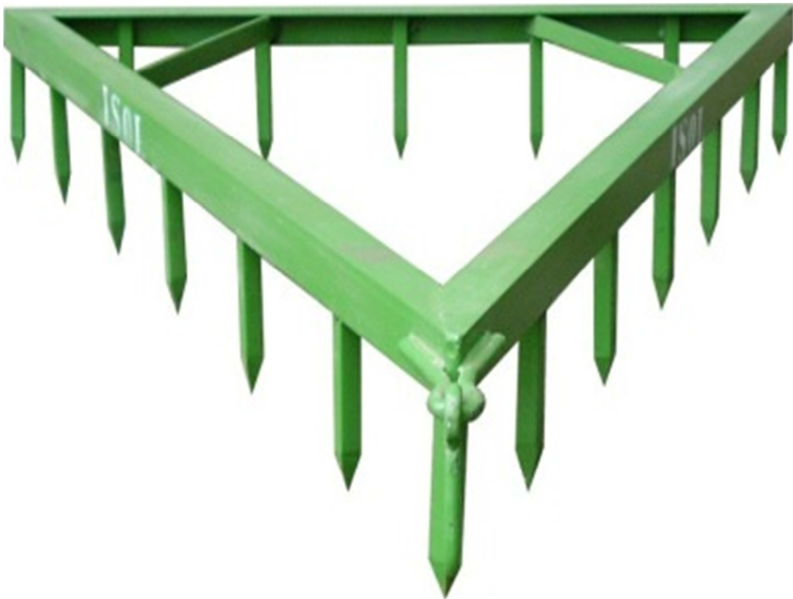
Figura 6. Grade de dentes à tração animal usada no plantio convencional
