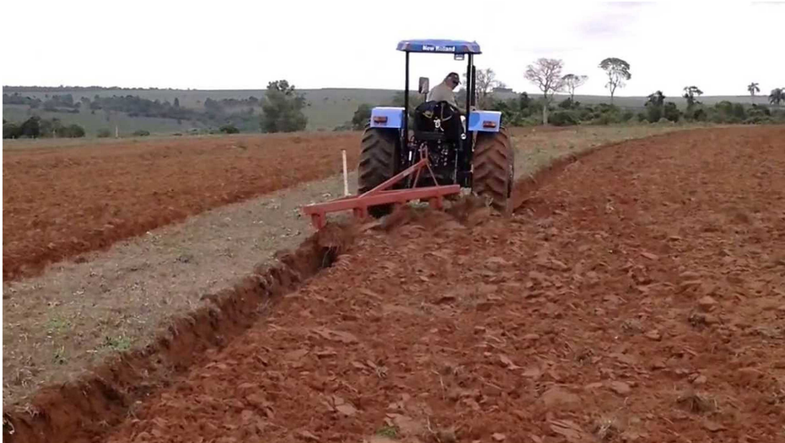
Figura 5. Trator arando o solo no plantio convencional com arado motomecanizado de quatro aivecas
