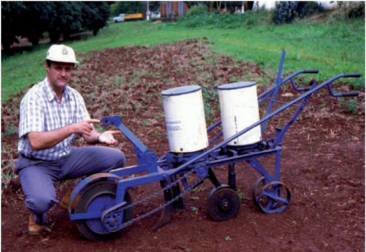
Figura 11. Primeiro modelo de semeadora de tração animal, Gralha Azul.
