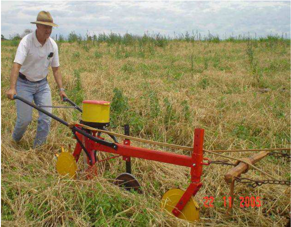
Figura 13. Plantadeira de tração animal para o plantio direto produzida pela Fitarelli de Aratiba, RS
