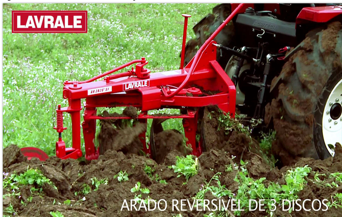
Figura 4 - Arado de disco usado no plantio convencional motomecanizado
