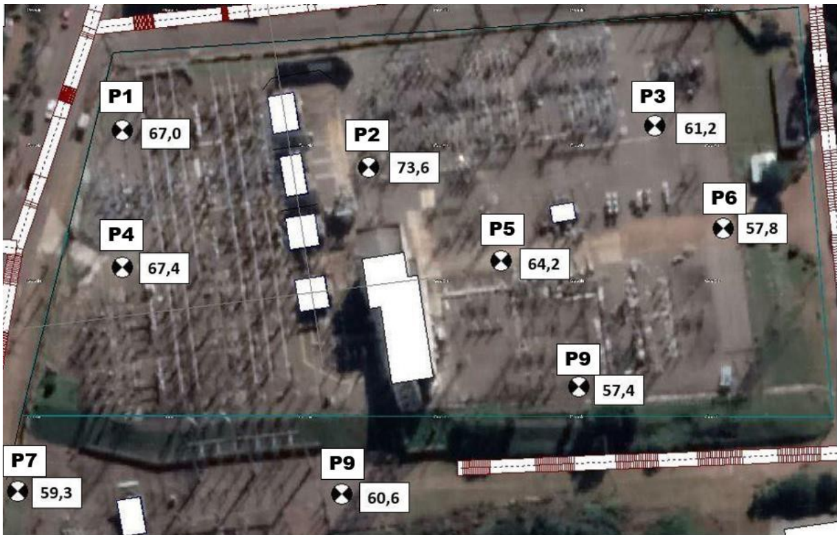
Figura 17 - Valores simulados com espectro obtido por medições “ in-loco ” e acréscimo referente a som tonal em dB.
