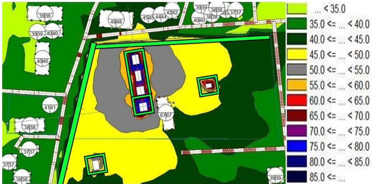
Figura 24 - Mapa de distribuição do ruído na subestação para a configuração C5, apresentando valores incidentes nas residências em dB.
