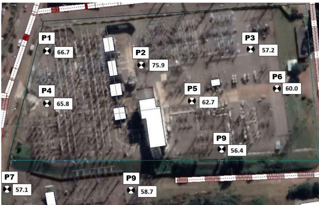
Figura 16 - Valores medidos em cada um dos pontos durante ensaio “ in-loco ” na subestação em dB.
