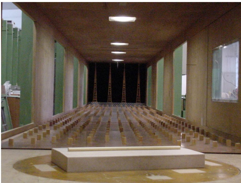
Figura 32: Características do túnel de vento para simulação do vento tipo  $p = 0,23$ .
