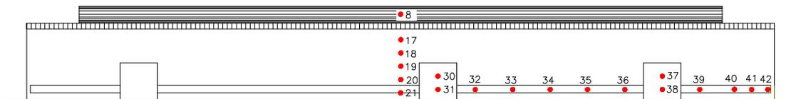
Figura 29: Tomadas de pressão da parede lateral.
