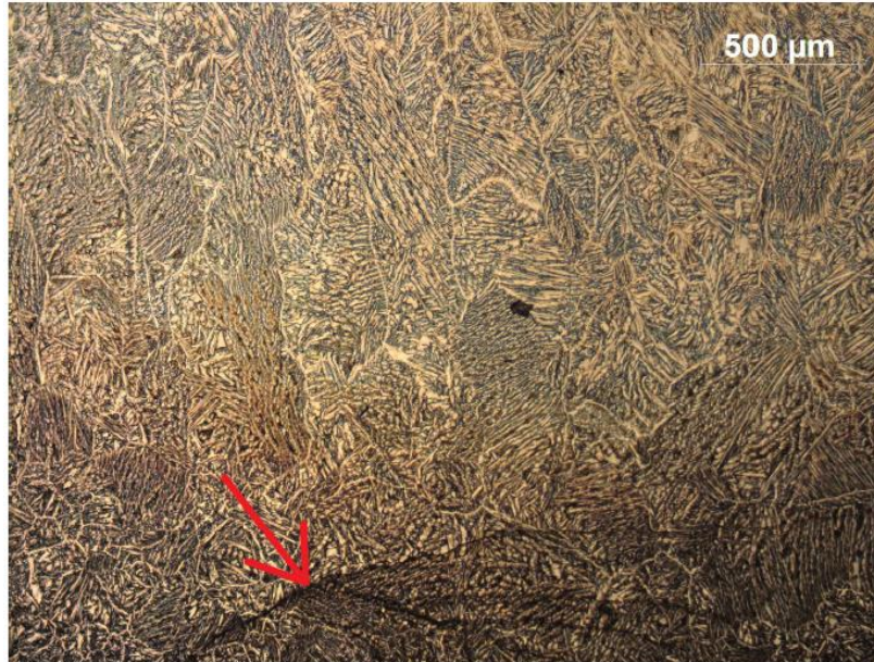
Figura 32 - Trincas no revestimento com frequência de vibração de 15 Hz, ampliação 50x.
