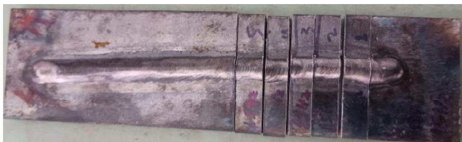
Figura 20 - Cordão de solda 15Hz.
