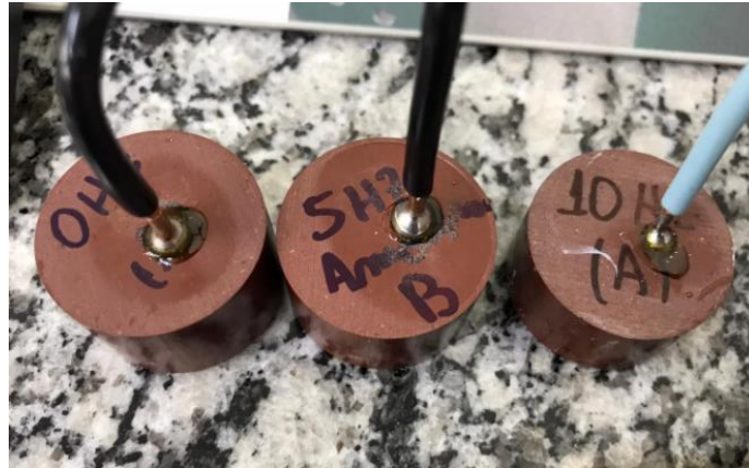
Figura 34 - Amostras soldadas para ensaio de corrosão
