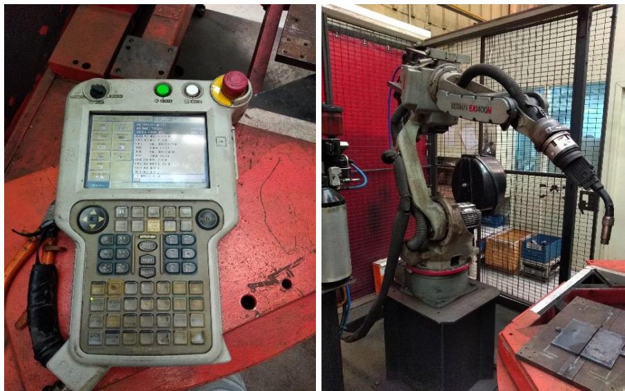
Figura 16 - Manipulador e Robô de soldagem
