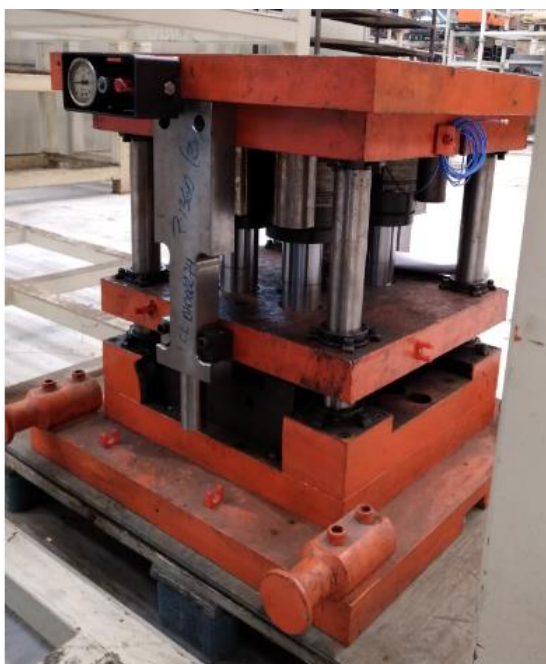
Figura 29 –Ferramenta de testes montada
