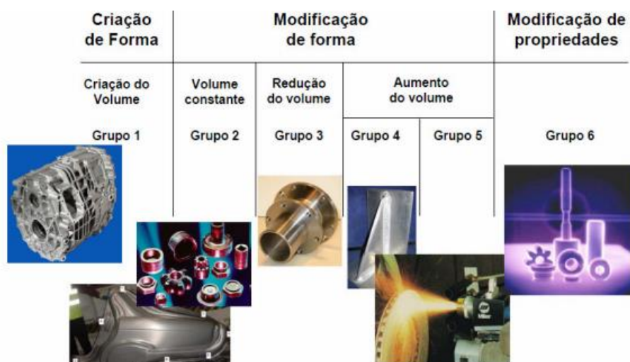
Figura 1 – Classificação dos processos de fabricação conforme DIN 8580
