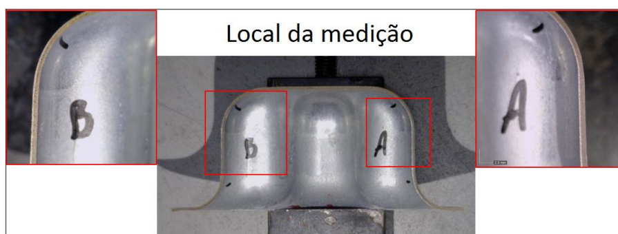
Figura 24 – Regiões de medição das espessuras
