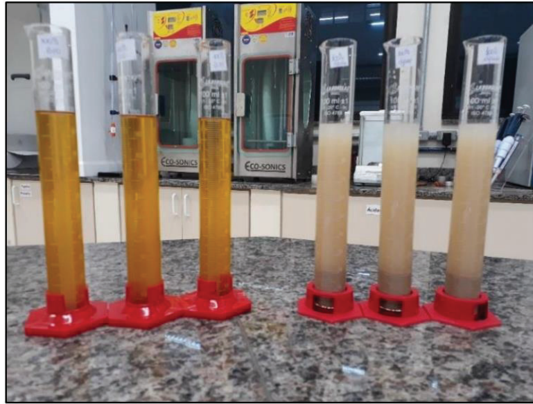
Figura 11: Ensaio de Expansão da bentonita
