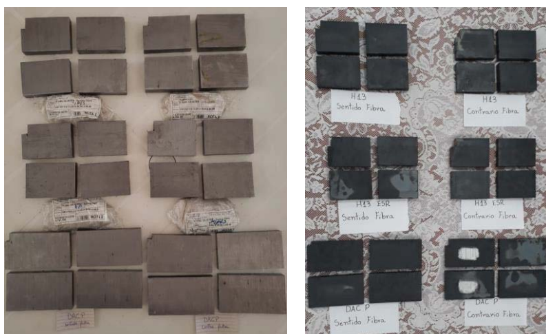
Figura 11: Amostras antes e após processo de tratamento térmico
