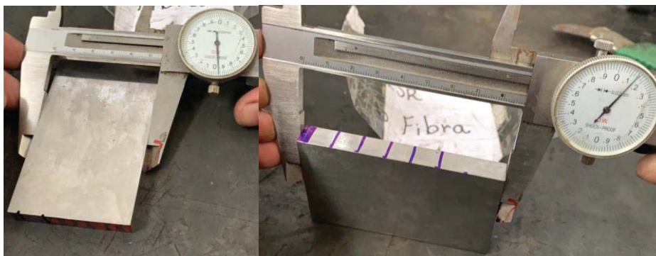
Figura 13: Peças retificadas com dimensões (10mm x 55mm x comprimento a ser cortado)
