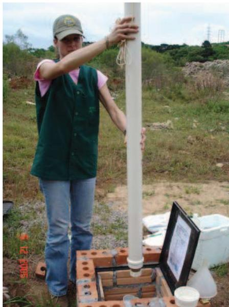
Figura 3.11: Amostrador para coleta de água subterrânea em poço de monitoramento.
