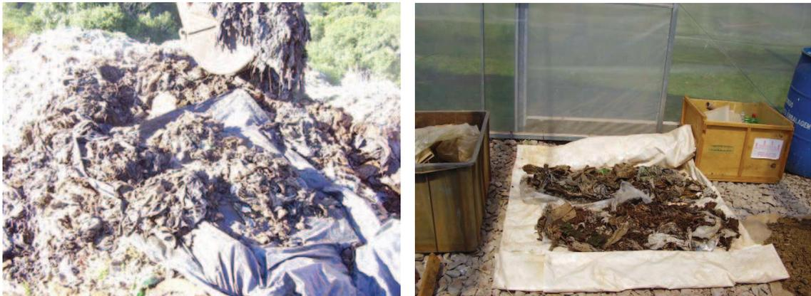
Figura 3.8a e 3.8b: Quarteamento de resíduos sólidos urbanos e amostra secando em estufa plástica na Universidade de Passo Fundo.
