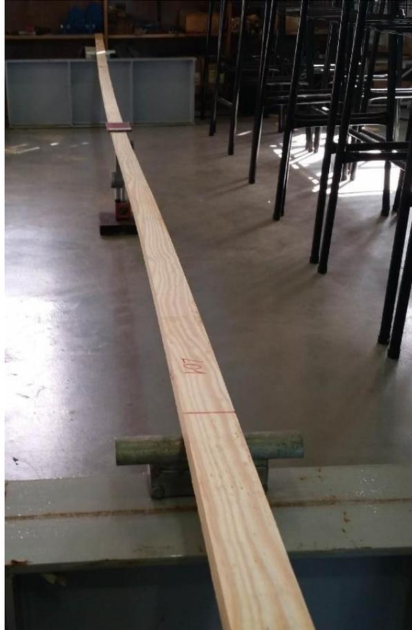
Figura 34: Posicionamento do manômetro e da carga no ensaio de flexão estática.
