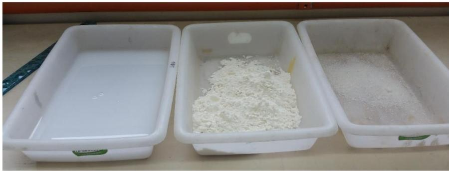
Figura 21: Mistura pronta do adesivo a base de UF.
