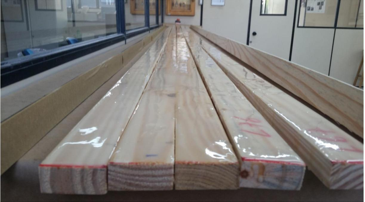
Figura 38: Viga teste montada com a pressão dos sargentos aplicada.
