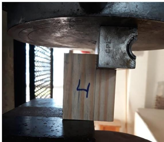
Figura 29: Preparação dos corpos de prova assimétricos para ensaio de cisalhamento.
