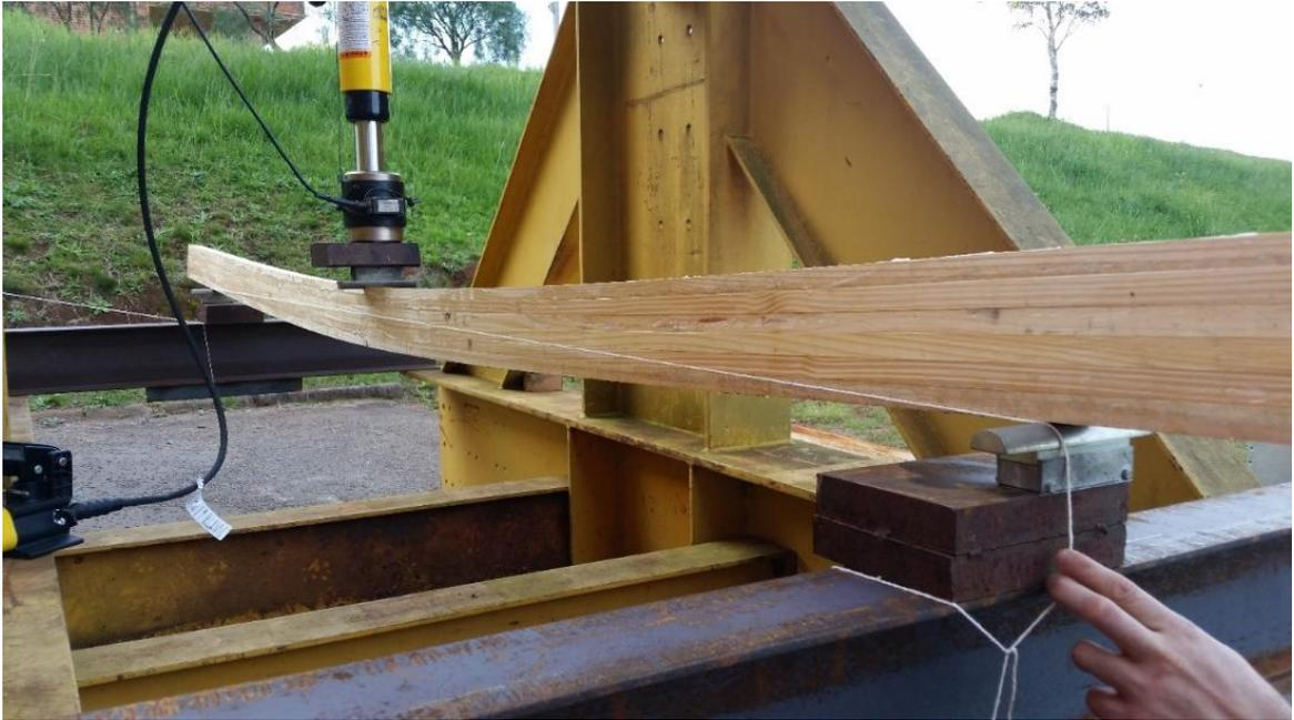
Figura 58: Deformação residual após o alívio do carregamento máximo da viga teste.
