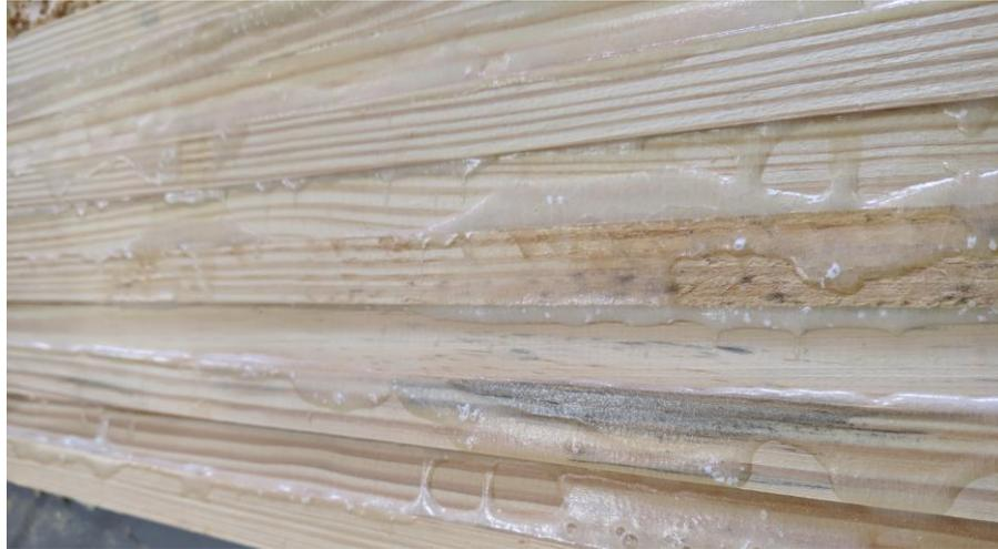
Figura 41: Viga de MLC após ser plainada.
