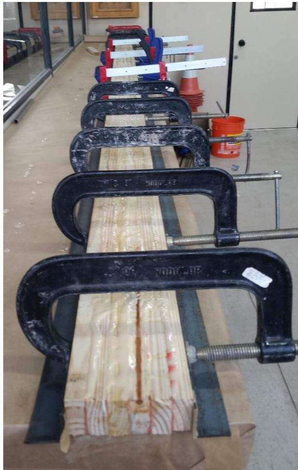
Figura 39: Viga pronta após 24 horas de cura do adesivo.
