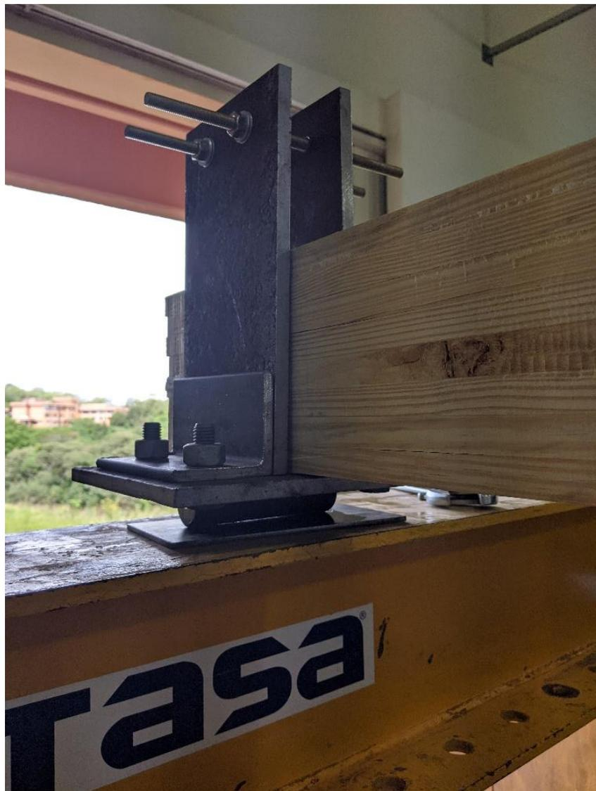
Figura 46: Dispositivo de apoio 2 do ensaio de instabilidade lateral.
