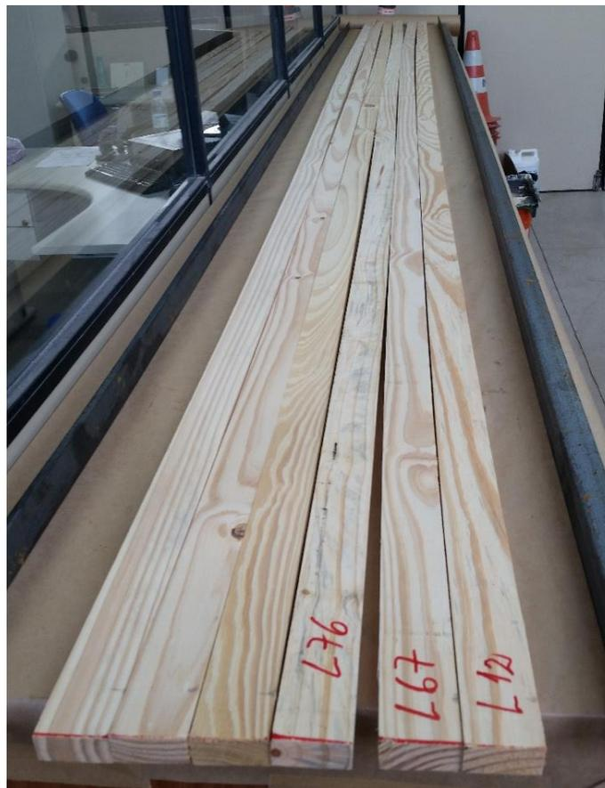
Figura 37: Lamelas após o recebimento do adesivo a base de UF.
