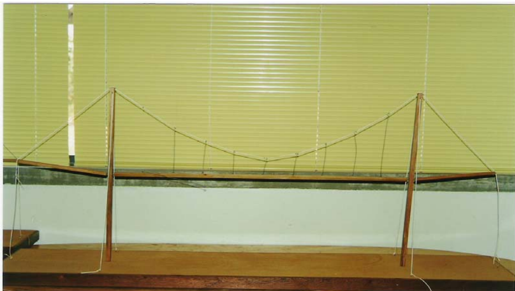
Figura 46 – Protótipo de um elemento estrutural para estudo de juntas e apoios – Unimep.
